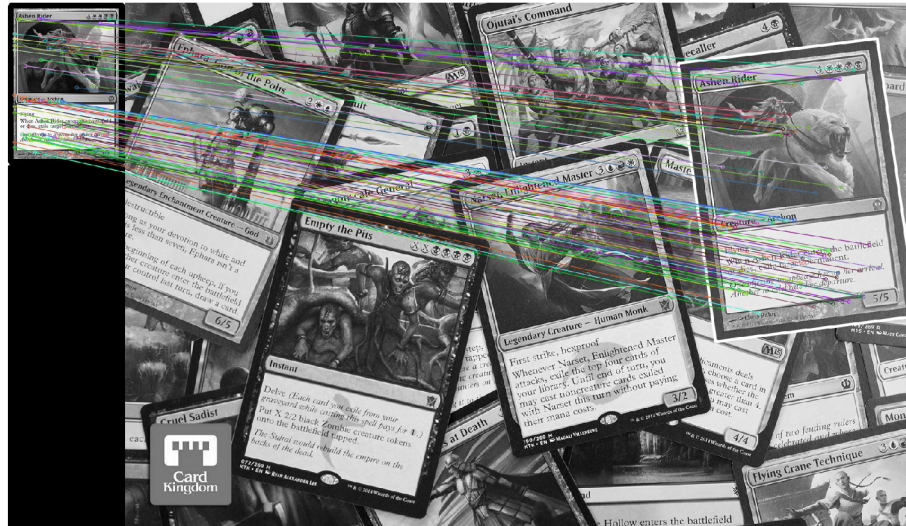
Obrázek 5.7: Nalezení objektu v obraze. Příklady vytvořeny v programu zrealizovaném v rámci práce. Pro tento příklad byl použit algoritmus SIFT, k-rozměrný strom, a metoda RANSAC.
