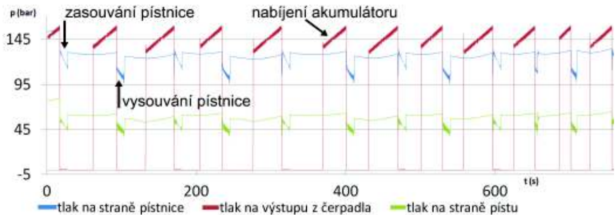
Obrázek 77: Experimentální měření - detail časových průběhů tlaků
