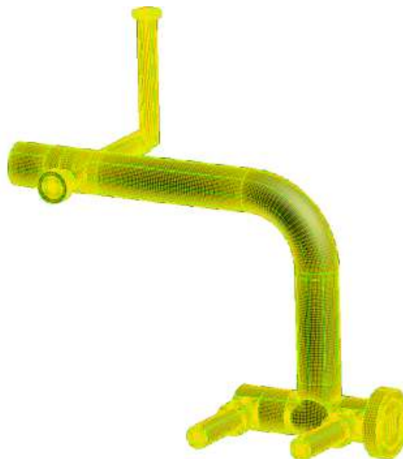
Obrázek 25: Rozložení sítě - přívod tlakového oleje
