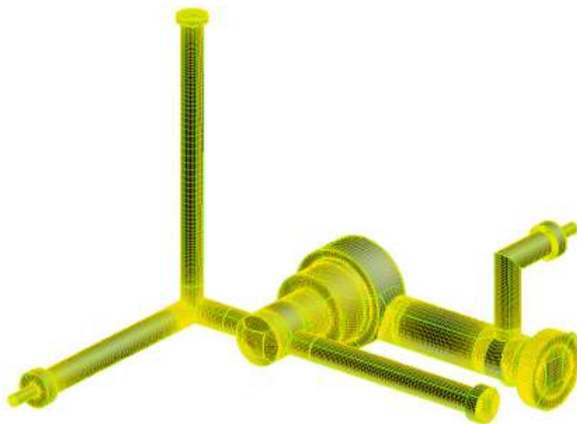
Obrázek 32: Rozložení sítě - kanál určený pro průtok oleje na píst, respektive od pístu
