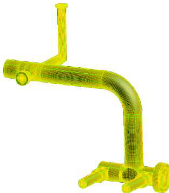
Obrázek 25: Rozložení sítě - přívod tlakového oleje
