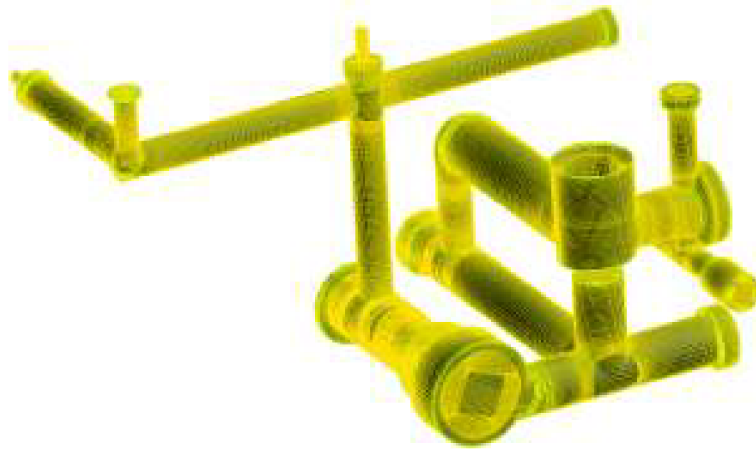
Obrázek 35: Rozložení sítě - kanál odvádějící olej ze strany písnice
