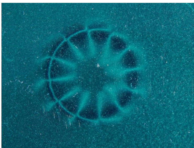
Obrázek 61: Magnetické pole rotoru elektromotorku CD-ROM zobrazené flux detektorovou fólií.
