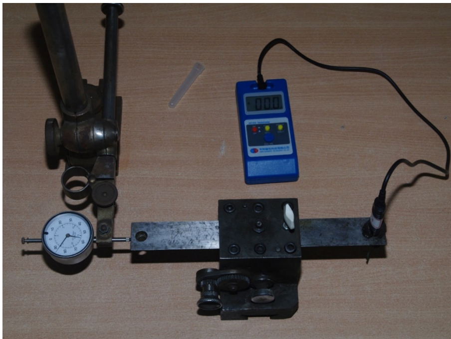
Obrázek 3: Měření magnetické indukce teslametrem Akaigu WT10A
