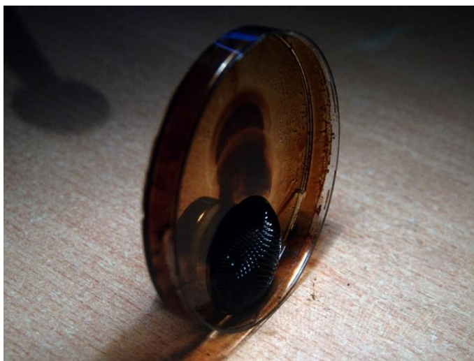
Obrázek 35: Magnetické pole nedovolí kapalině ferrofluid uniknout z misky.
