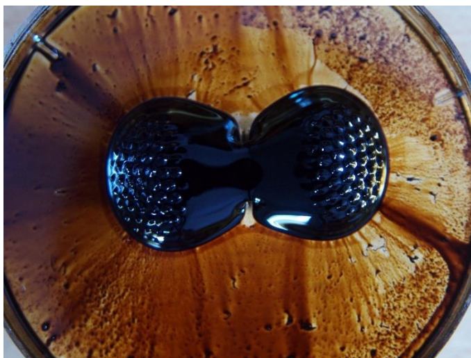
Obrázek 43: Ferrofluid zobrazující magnetické pole krychlových magnetů v uspořádání SJ-SJ.
