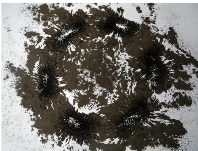
Obrázek 58: Magnetické pole rotoru zapalování ČZ 125/150 zobrazené železnými pilinami.
