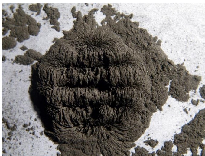
Obrázek 49: Zobrazení magnetického pole multipólově magnetovaného magnetu železnými pilinami.
