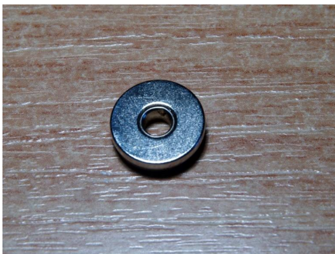
Obrázek 60: Neodymový prstencový magnet ze statoru elektromotorku CD-ROM.
