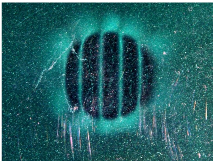
Obrázek 48: Zobrazení magnetického pole multipólově magnetovaného magnetu flux detektorem
