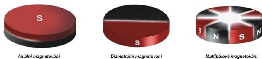
Obrázek 20: Směr magnetizace diskových a válcových magnetů. Převzato z [21]
