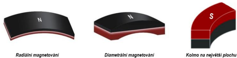
Obrázek 24: Možnosti magnetování segmentových magnetů. Převzato z [21]
