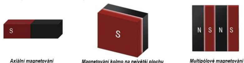
Obrázek 21: Směr magnetizace kvádrových magnetů. Převzato z [21]
