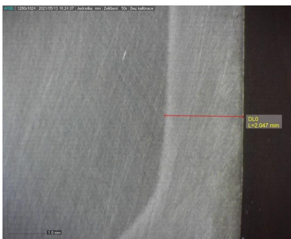
Obr. 56 – Šířka TOO tělesa T3: střední oblast řezu. Naměřená šířka: 2,047 mm
