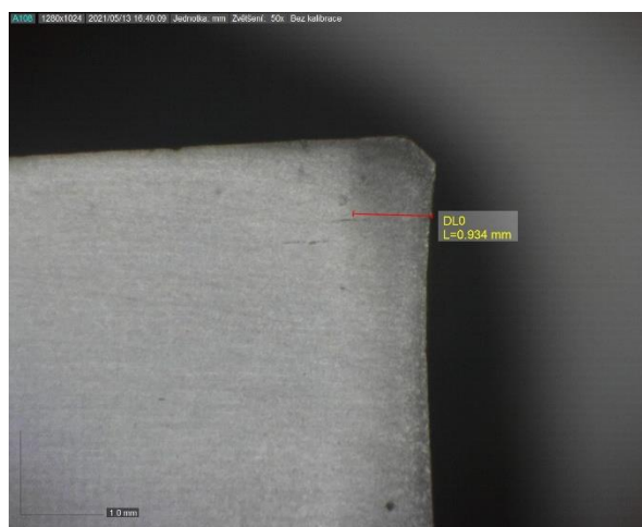
Obr. 51 – Šířka TOO tělesa T2-1: počátek řezu. Naměřená šířka: 0,934 mm
