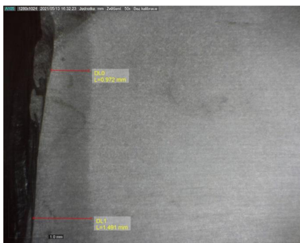
Obr. 50 – Šířka TOO tělesa T2-2: počátek řezu. Naměřená šířka: 0,972 mm
