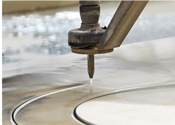
Obr. 13 – Řezání vodním paprskem [49]
