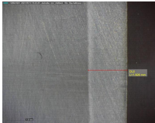
Obr. 55 – Těleso T3: počátek řezu. Naměřená šířka: 1,926 mm
