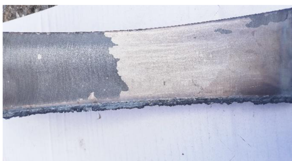
Obr. 36 – Povrch řezu tělesa T3 (XAR®)
