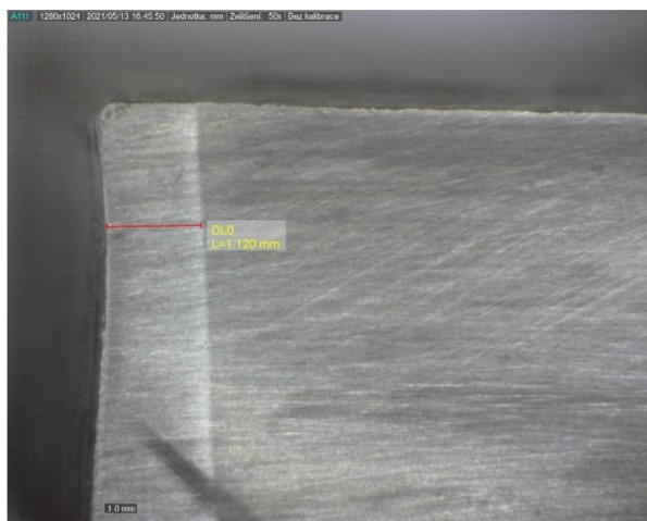
Obr. 46 – Šířka TOO tělesa T1-2: počátek řezu. Naměřená šířka: 1,120 mm
