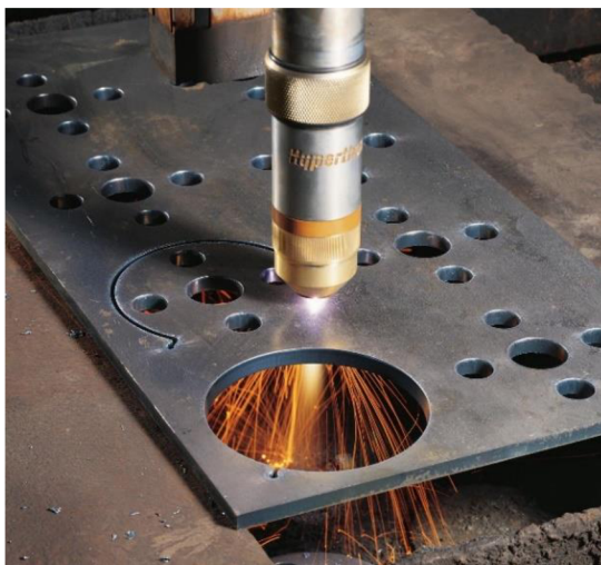
Obr. 1 – CNC řezání paprskem plazmy [3]
