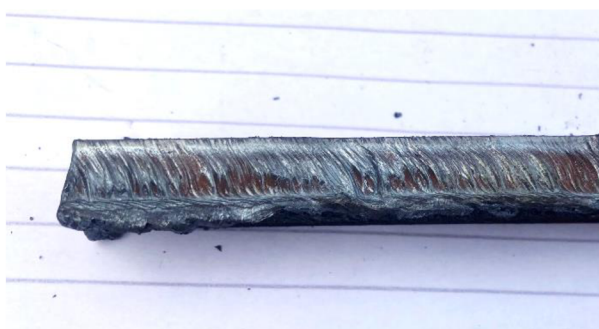
Obr. 35 – Povrch řezu tělesa T2-2 (DOMEX)
