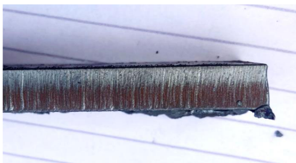
Obr. 34 – Povrch řezu tělesa T2-1 (DOMEX)
