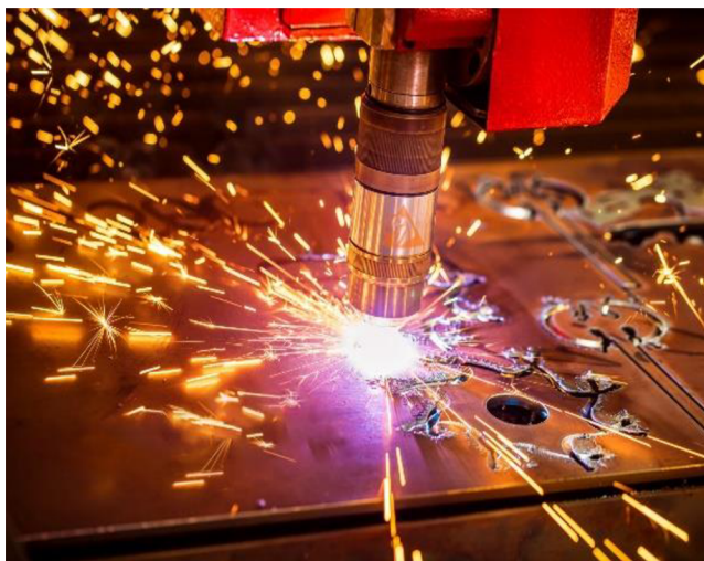
Obr. 2 – CNC tvarové řezání plazmou [4]
