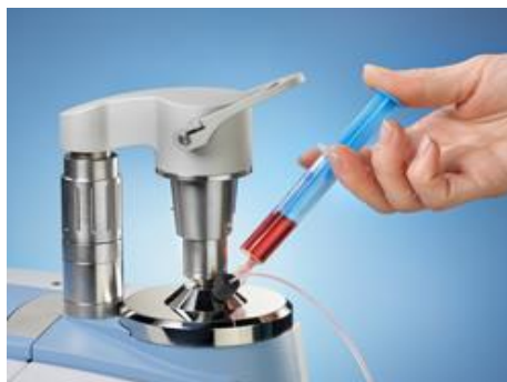
Obrázek 8 Analyzátor Alpha wine ATR (www.brukeroptics.cz, 2016)
