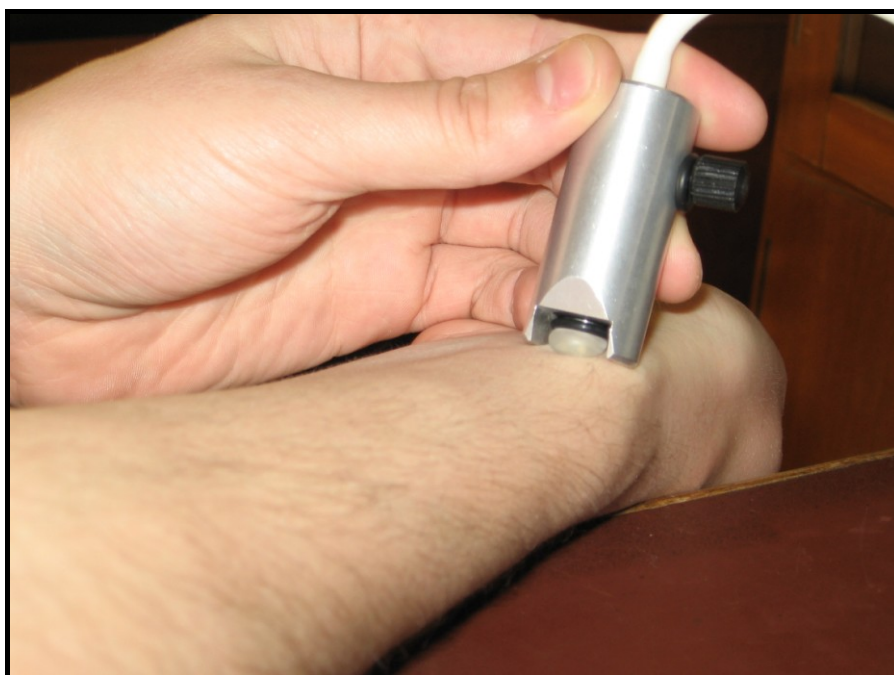
Obr. 5. Znázornění způsobu přiložení měřicí sondy na vyšetřované místo, konkrétně na arteria radialis.
