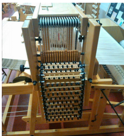
Obr. 14 Kartový pás ovládající prošlup osnovních nití
