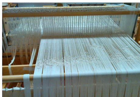
Obr. 15 Přísuk nové a předešlé osnovy
