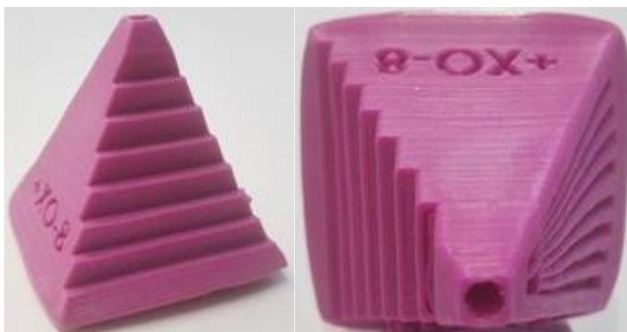
Obrázek 16 - Vzorek z PLA po leptání v parách DCM
