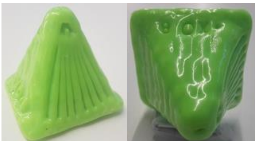
Obrázek 13 - Vzorek z ABS po leptání v parách roztoku acetonu a DCM
