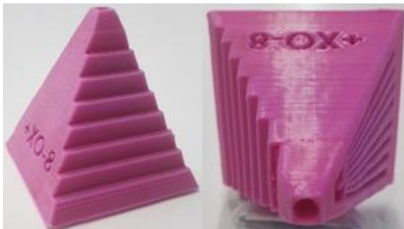
Obrázek 20 - Vzorek z PLA po leptání v parách THF
