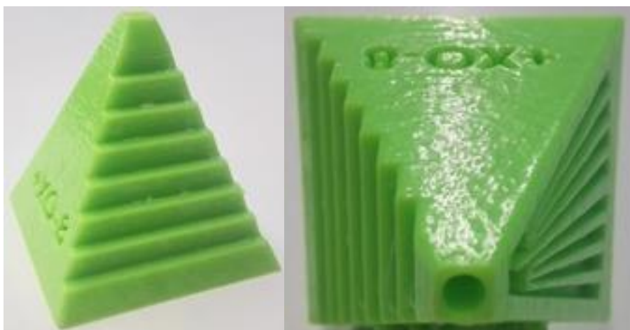
Obrázek 26 - Vzorek z ABS po leptání v aerosolu roztoku acetonu a DCM
