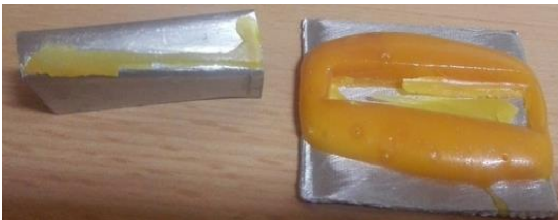
Obrázek 30 - Vzorek epoxidového spoje po vystavení acetonu
