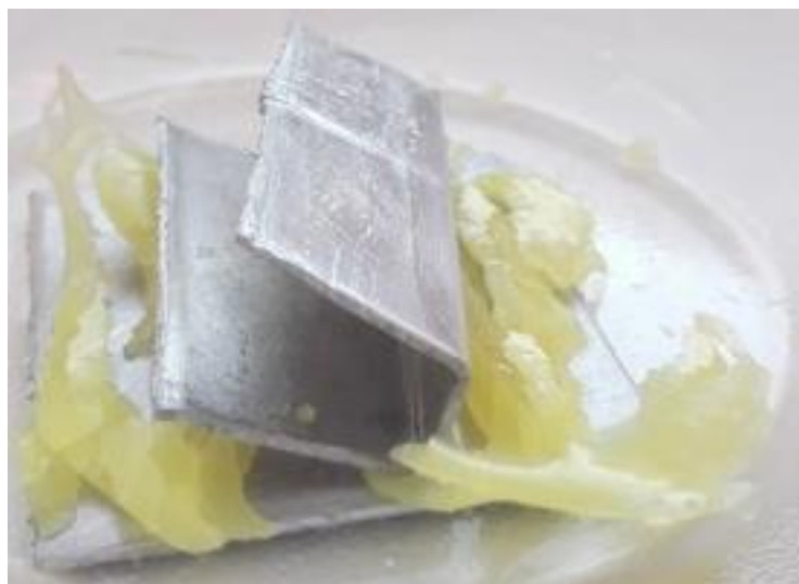
Obrázek 31 - Vzorek epoxidového spoje po vystavení DCM
