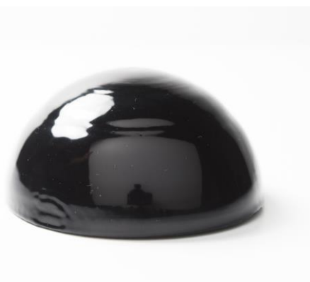
Obrázek 6 - Příklad povrchu vyhlazeného acetonovými parami [18]
