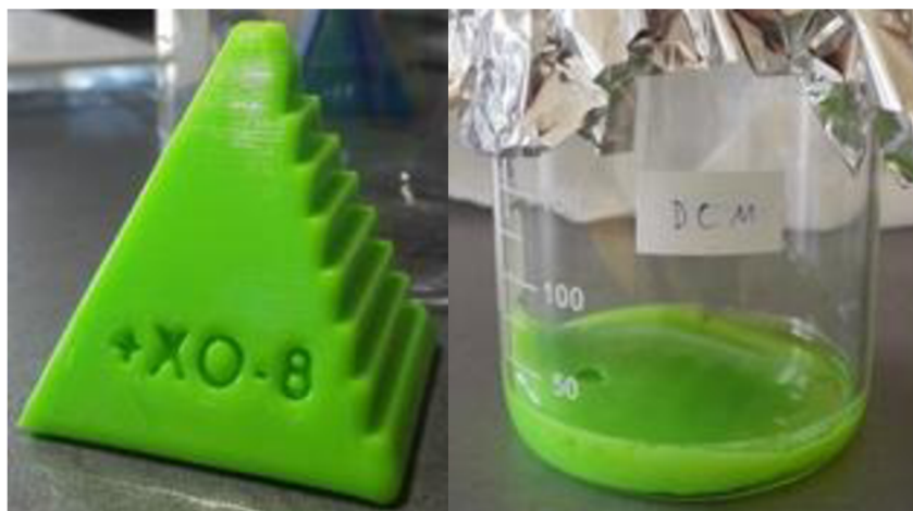
Obrázek 17 - Vzorek z ABS po leptání v parách DCM
