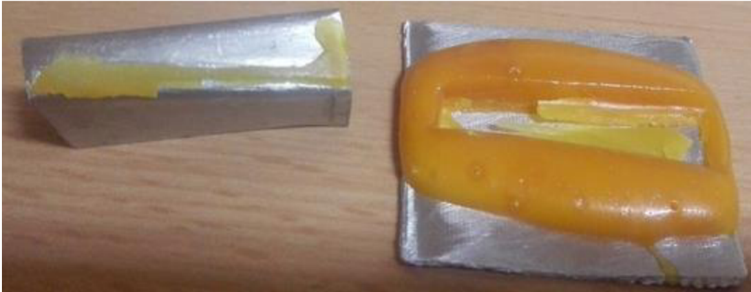
Obrázek 30 - Vzorek epoxidového spoje po vystavení acetonu
