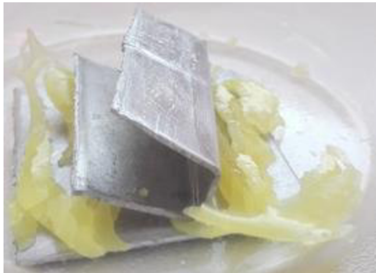
Obrázek 31 - Vzorek epoxidového spoje po vystavení DCM
