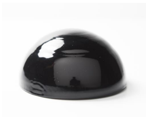
Obrázek 6 - Příklad povrchu vyhlazeného acetonovými parami [18]
