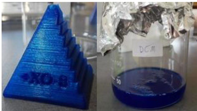
Obrázek 19 - Vzorek z SBS po leptání v parách DCM
