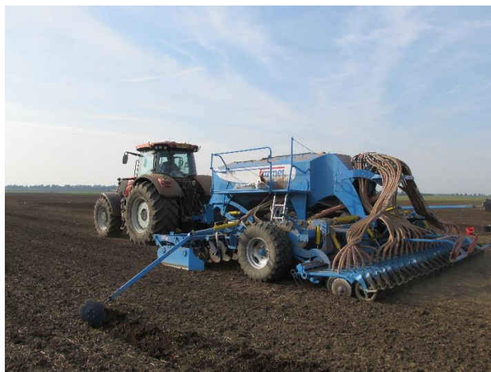
Obr. 2: Založení porostů ozimé pšenice se současným výsevem hrachu ob meziřádek 26.9.2016 secím strojem Falcon pro výsev dvou druhů plodin ob botku (foto Brant).
