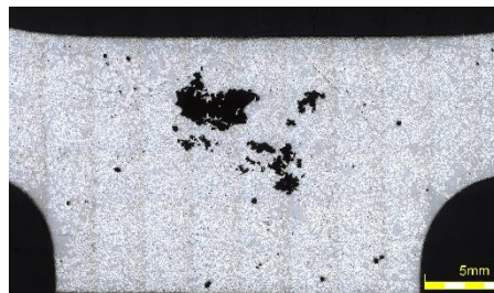
Obr. 3-16 Makrostruktura třetí vady – boční pohled
