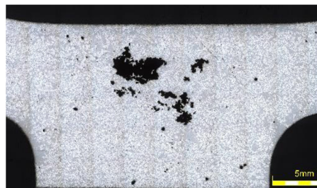
Obr. 3-16 Makrostruktura třetí vady – boční pohled
