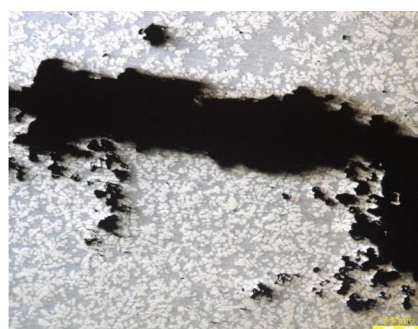
Obr. 3-9 Mikrostruktura první vady
