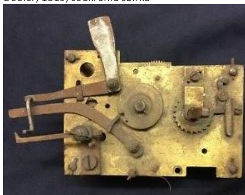
Obr. 66 Podružný strojek z rámových hodin pro různé pohyby automatů, soukromá sbírka
