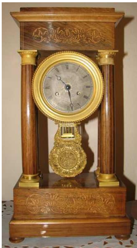
Obr. 80 Sloupkové hodiny s teplotně kompenzačním kyvadlem, Francie, Starožitnosti Antik, Vinohrady, 5. 7. 2018
