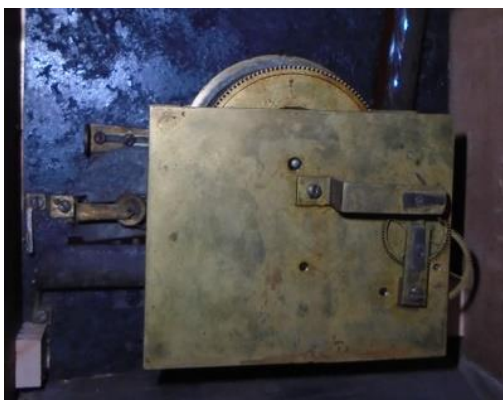
Obr. 13 Mechanismus vodopádu poháněný velkým pérovníkem, sloupkové hodiny, Muzeum Jindřichohradecka, inv. č. HO 179
