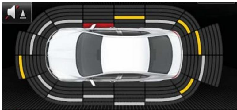
Obrázek 9 Kontrola prostoru kolem celého vozidla [20]
