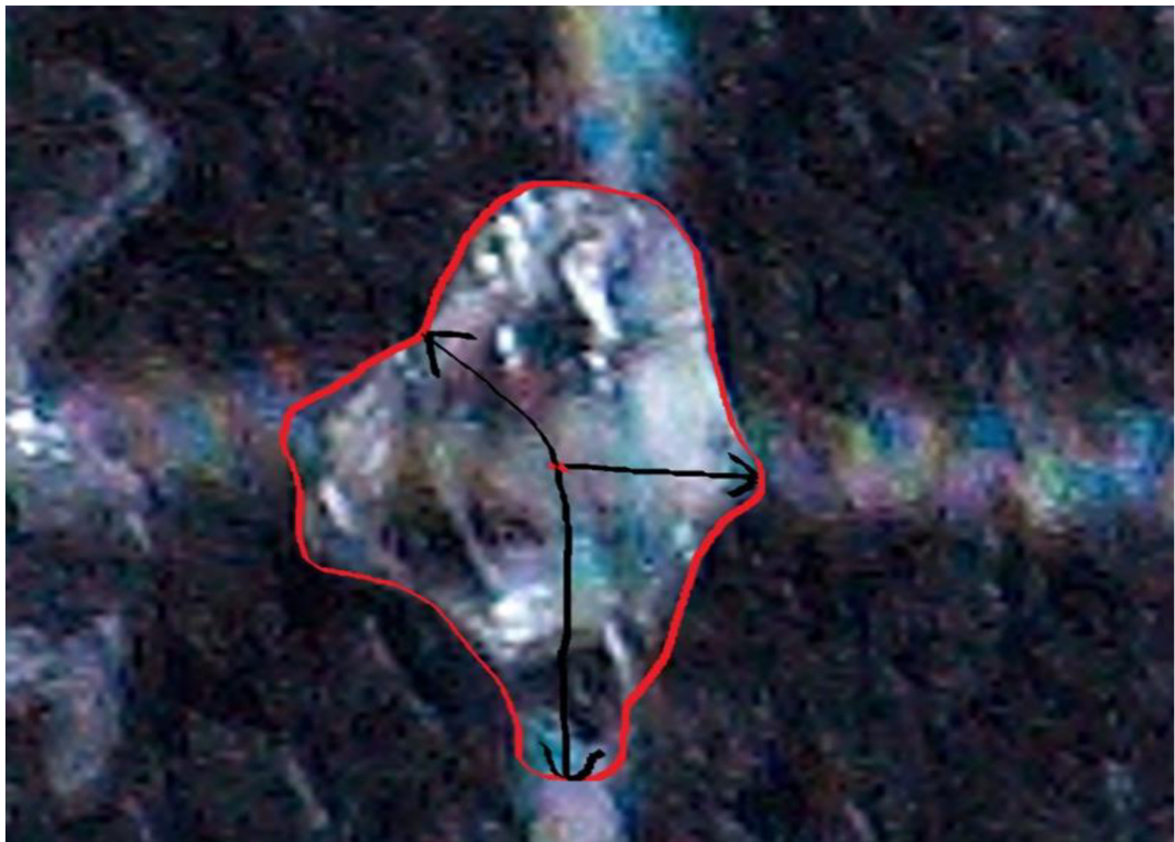
Obrázek 11: Problematické určení poloměru sněhového zrna.
