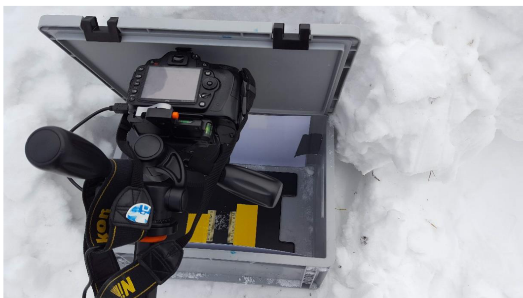
Obrázek 9: Fotografická sestava na pořizování snímků odebraných vzorků sněhu (Foto: Roman Juras).
