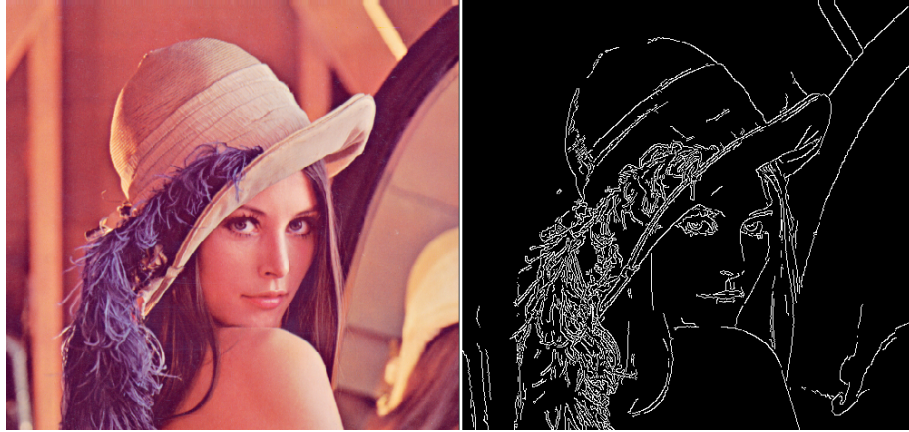
Obrázek 2.12: Výřez výsledku z aplikace po převedení obrazu do stupňů šedi a použití metody cv2.Canny(vstup, min, max) . Zadané parametry min = 80 a max = 200 . Další parametry aperture_size a L2gradient jsou nepovinné a byly nechány v defaultních hodnotách, tedy 3 a false . aperture_size je velikost Sobelovy masky a L2gradient představuje použití přesnějšího vzorce.
