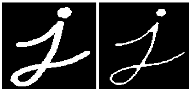
Obrázek 2.15: Ukázka z aplikace za použití knihovny OpenCV a metody cv2.erode(vstup, jádro, iterace) . Jádro je čtvercové 5 \times 5 vytvořené pomocí metody cv2.getStructuringElement a iterace byla nastavena na 1.
