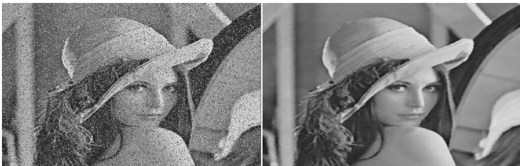
Obrázek 2.8: Aplikace mediánového filtru s 5 \times 5 maskou. Obraz přišel o malé ztráty jemných detailů a vypadá poněkud „změkčeně“. Snímek pochází z výřezu aplikace s pomocí funkcí knihovny OpenCV.
