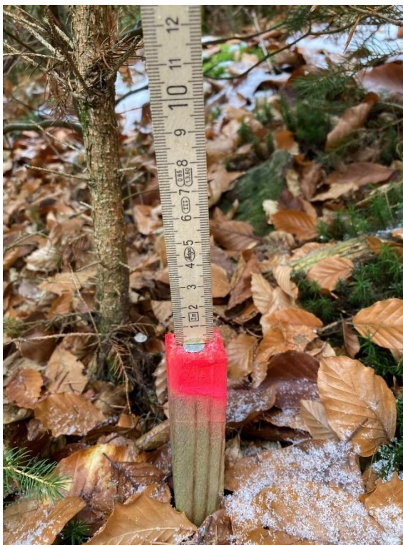
Příloha 3: Přiložení skládacího metru na měrný kolík (foto autor)
