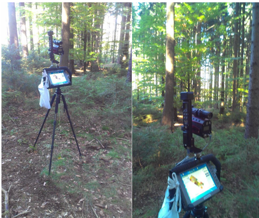
Obr. 12: Sestava Field-Map při vytyčování bodové sítě na výzkumné ploše.
