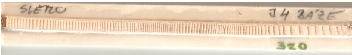
Obr. 24: Ukázka zpracované podoby dendrochronologického vzorku a jeho převedení do elektronické obrazové formy pro následnou počítačovou analýzu obrazu (zde je celková kvalita obrazu snížena zmenšením paměťové kapacity obrázku komprimací z formátu .BMP do .JPEG).
