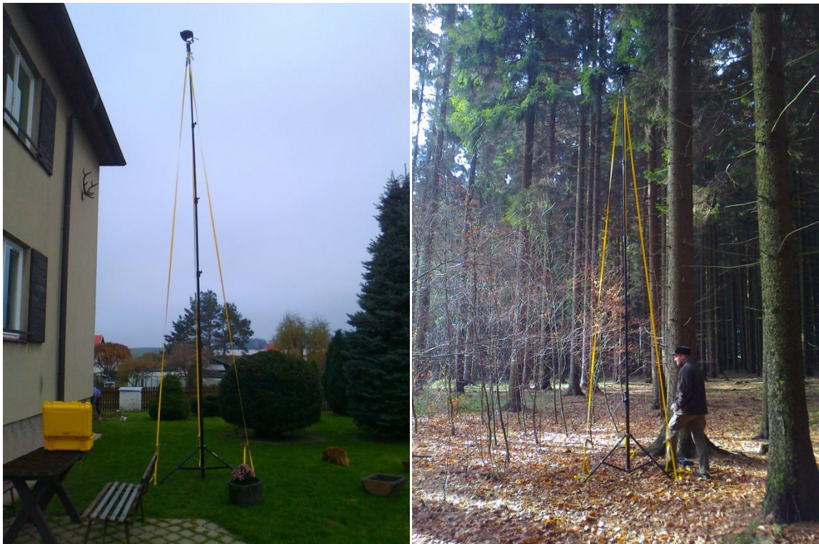
Obr. 10: Sestava „Fish-eye“ na samo-nivelační plošině umístěné na vysunutém stativu, stabilizovaná proti kmitu stativu kurtami; vlevo zcela vysunutá v průměru k výšce dvoupatrového domu; vpravo zčásti vysunutá při terénním sběru dat (figurant 190 cm).
