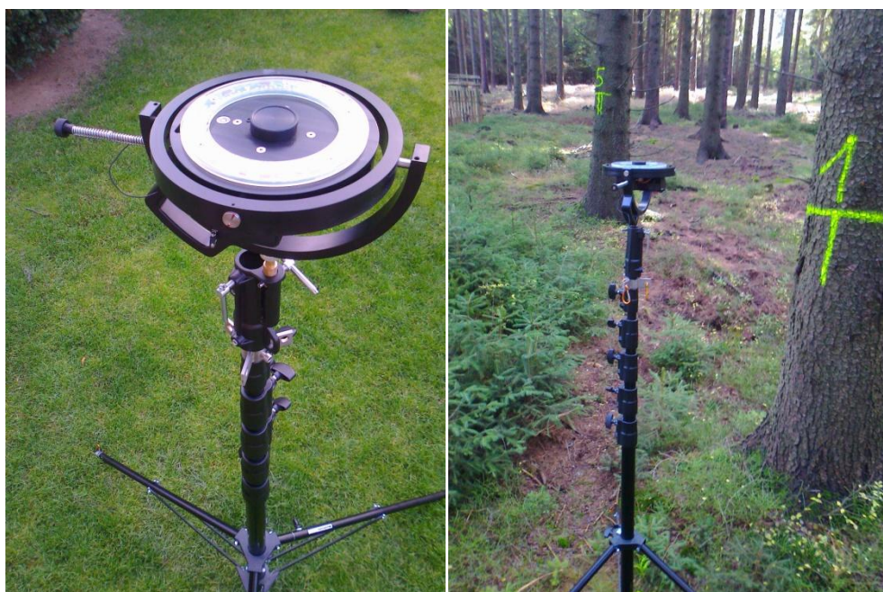
Obr. 9: Kompletní podoba sestavy pro pořizování hemisférických snímků sestávající z výsuvného stativu Manfrotto 269 HDB v základním, složeném stavu, samo-nivelační plošiny s integrovaným fotoaparátem, širokouhlým objektivem (zakrytý), přijmačem signálu dálkové spouště, automatickým detektorem magnetického pólu Země, kontrolní vodováhou, aretačním šroubem plošiny.
