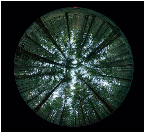
Obr. 8: Ukázka podoby hemisférické fotografie pořízené v lesním porostu v rámci nepřímé metody měření porostního světla, snímek zobrazuje výšeč v úhlu 180°, pozice červené diody ukazuje severní magnetický pól Země.
