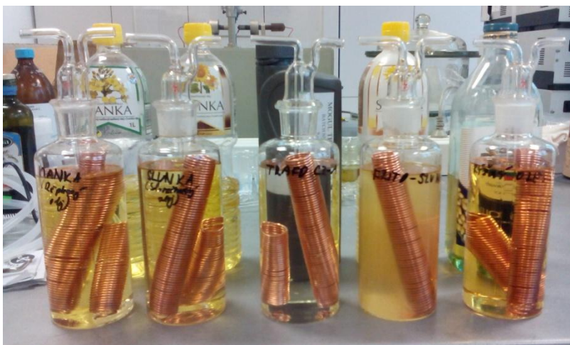
Obr. 25: Promývací baňky naplněné oleji a měděným drátem, zleva: řepkový olej, slunečnicový olej, TRAFO-CZA, FRITO a rýžový olej.
