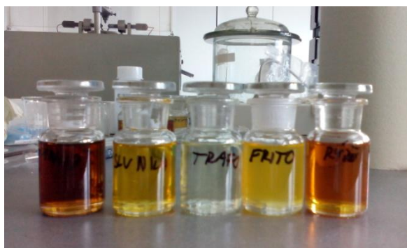
Obr. 37: Barva vzorků po namáhání dlouhém 100h. Zleva: řepkový olej, slunečnicový olej, TRAFO-CZA, olej FRITO a rýžový olej
