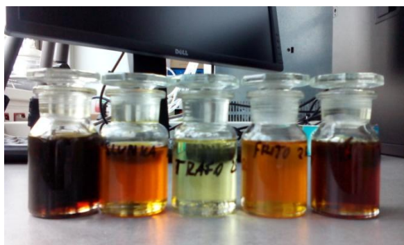
Obr. 38: Barva vzorků po namáhání dlouhém 250h. Zleva: řepkový olej, slunečnicový olej, TRAFO-CZA, olej FRITO a rýžový olej
