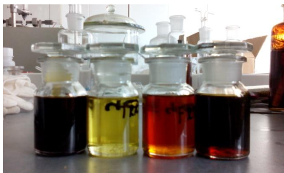
Obr. 39: Barva vzorků po namáhání dlouhém 500h. Zleva: řepkový olej, TRAFO-CZA, olej FRITO a rýžový olej
