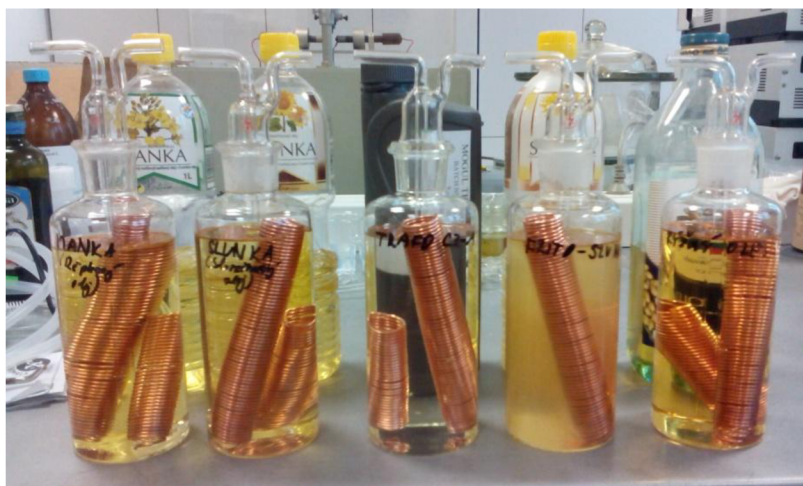
Obr. 25: Promývací baňky naplněné oleji a měděným drátem, zleva: řepkový olej, slunečnicový olej, TRAFICO-CZA, FRITO a rýžový olej.
