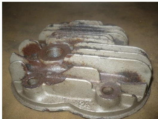
Obrázek 22, Hlava válce před renovací
