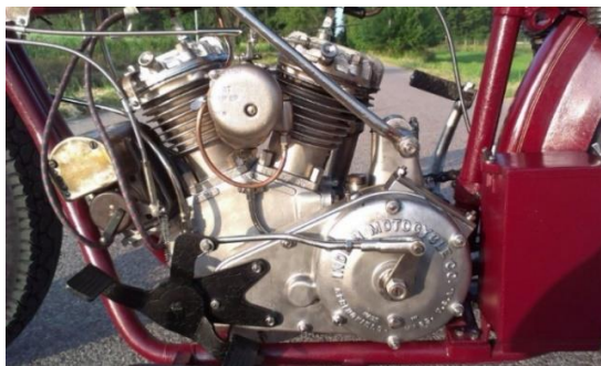
Obrázek 38, Zrenovovaný spalovací motor Indian Scout 600
