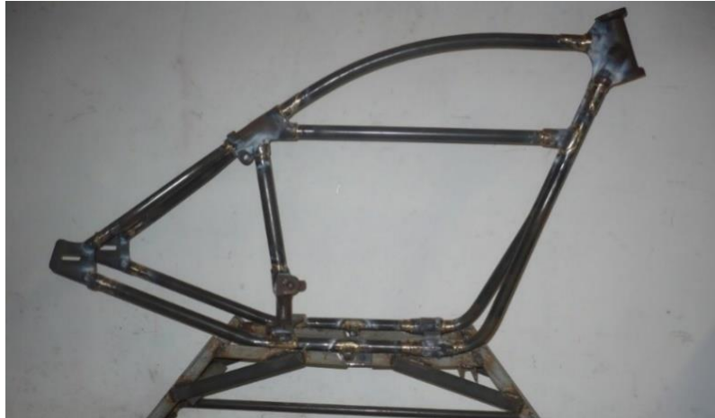
Obrázek 34, Finální podoba nového nosného rámu (bez držáků nádrže)
