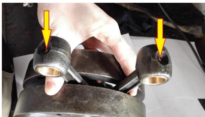
Obrázek 25, Provrtané hřbety ojníc
