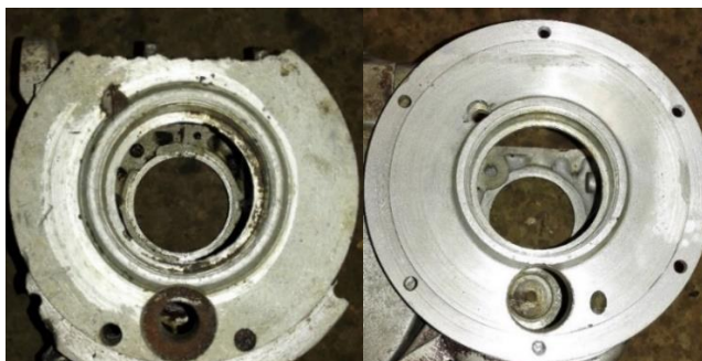
Obrázek 30, Oprava obalu převodovky
