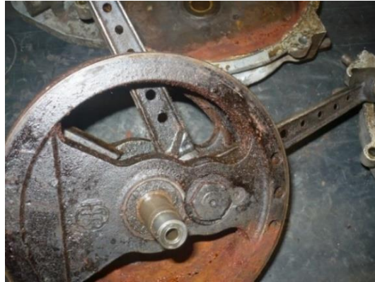
Obrázek 26, Kliková hřídel ve stavu před renovací
