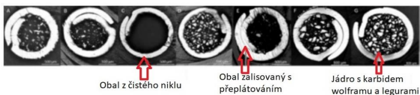
Obrázek 3, Typy plněných elektrod [8]
