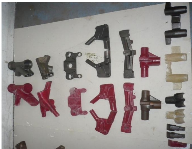
Obrázek 33, Odlitky a modely rámu
