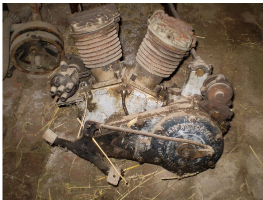
Obrázek 21, Výchozí stav motoru Indian Scout před renovací
