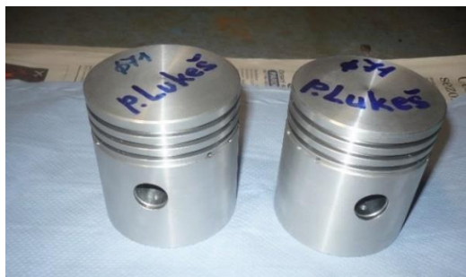
Obrázek 24, Nové písty vyrobené podle originálu
