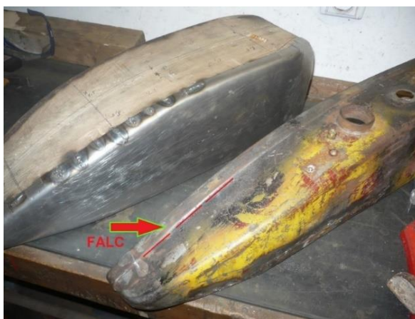
Obrázek 35, Postup výroby nádrže motocyklu
