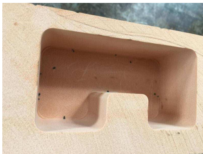
Obr. 4.8 Obrobená kapsa v umělém dřevě po dokončení.
