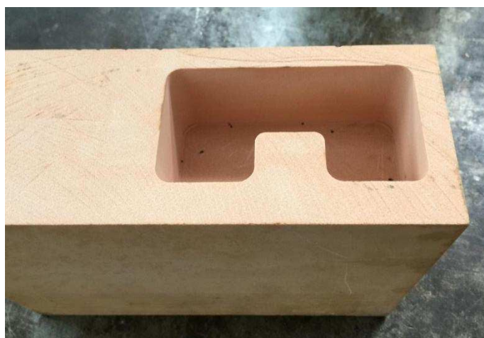
Obr. 4.7 Dokončená, obrobená kapsa v umělém dřevě.
