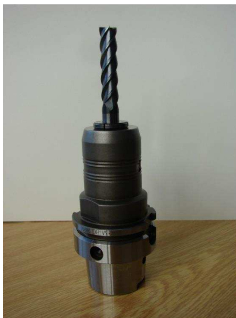
Obr. 4.5 Nástroj PRAMET 12E4S100-50A12 SUMA v upínači PRAMET HC 2090 (HSK 63A).
