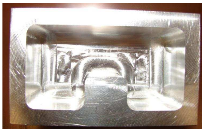
Obr. 4. 13 Dokončená kapsa s poloměrem R6.
