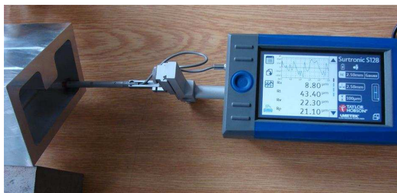
Obr. 4. 22 Drsnoměr AYLOR HOBSON Surtronic S – 128 a měření drsnosti v jednom z rohů kapsy.
