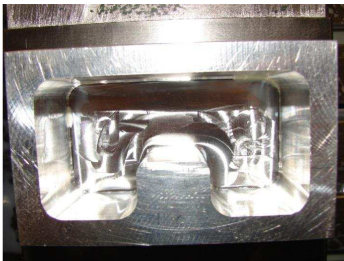
Obr. 4. 11 Kapsa po hrubování, pohled shora.
