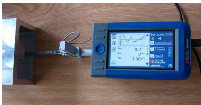
Obr. 4. 16 Drsnoměr AYLOR HOBSON Surtronic S – 128 a obrobena kapsa.
