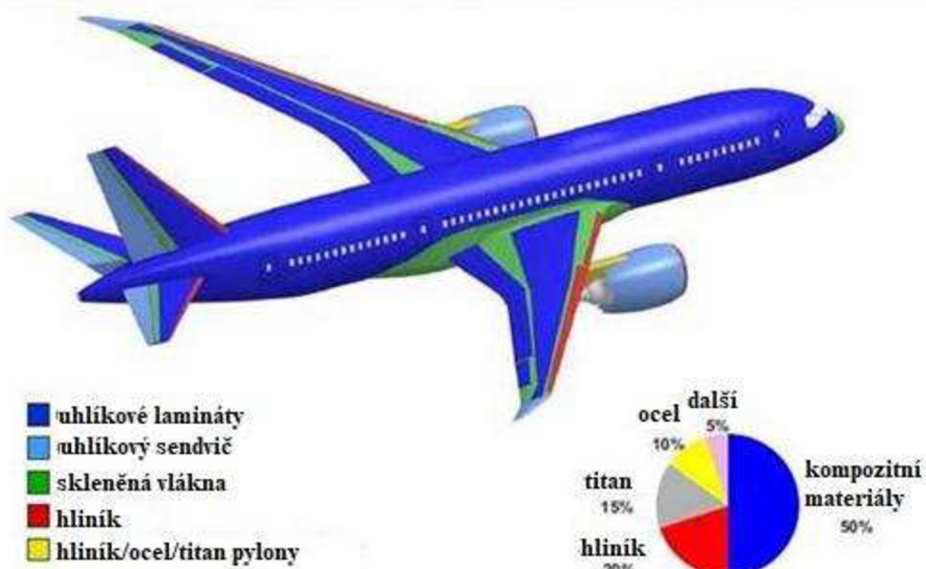
Obr.1.1 Materiály používané v letounu Boeing 787 [1].
