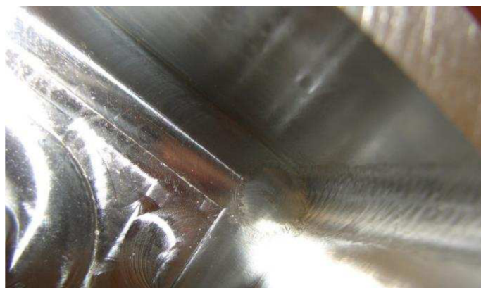
Obr. 4. 12 Detail nekvalitního povrchu kapsy v jednom z jejích rohů způsobený vibracemi dokončovacího nástroje.
