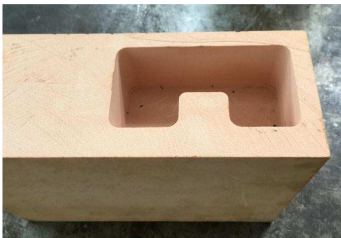
Obr. 4.7 Dokončená, obrobená kapsa v umělém dřevě.
