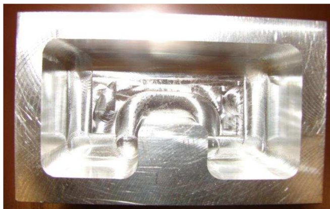
Obr. 4. 13 Dokončená kapsa s poloměrem R6.
