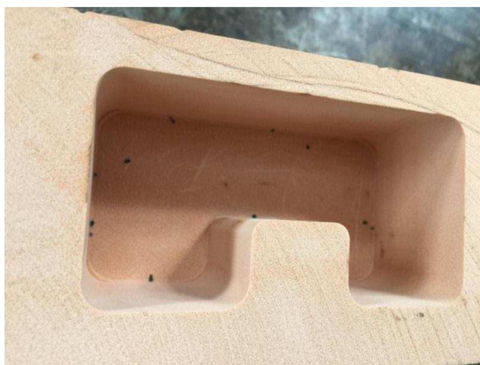
Obr. 4.8 Obrobená kapsa v umělém dřevě po dokončení.
