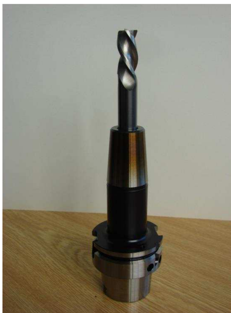
Obr. 4.3 Nástroj Monolit JS453160E2R100.0Z3-HEMI v upínači HSK-A63 D16 A120 CDB-01.
