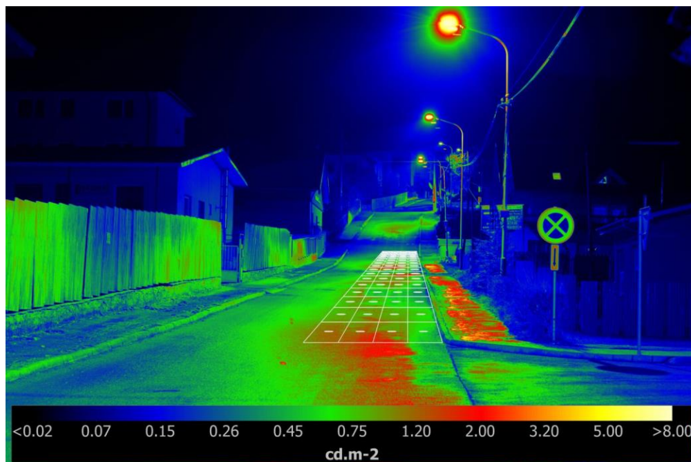
Obrázek 3.6 Ukázka výstupu měření pomoví LumiDISP [18]
