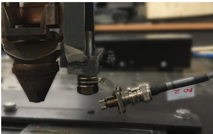
Obrázek 4.4: Boční fotodioda připevněná ke svařovací hlavě.
