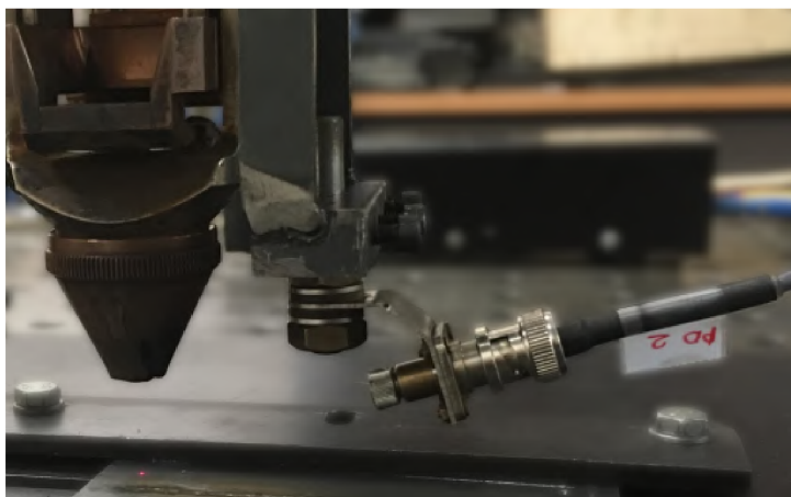
Obrázek 4.4: Boční fotodioda připevněná ke svařovací hlavě.
