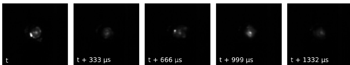
Obrázek 6.1: Série snímků při laserovém výkonu 1500 W, posuvné rychlosti 30 \text{ mm}\cdot\text{s}^{-1} a snímkovací frekvenci kamery 3003 Hz.
