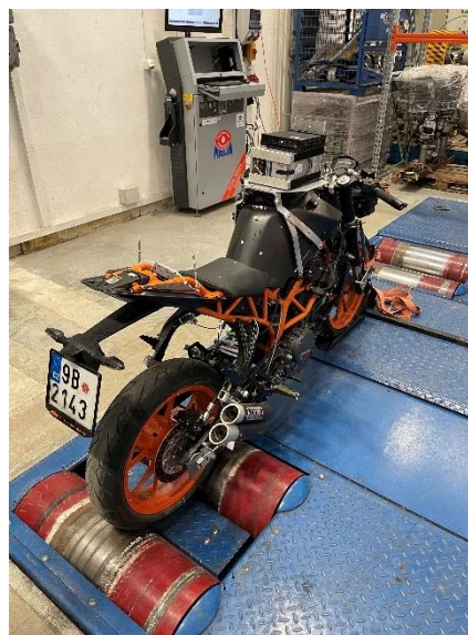
Obr. 25 Měření na válcové zkušebně
