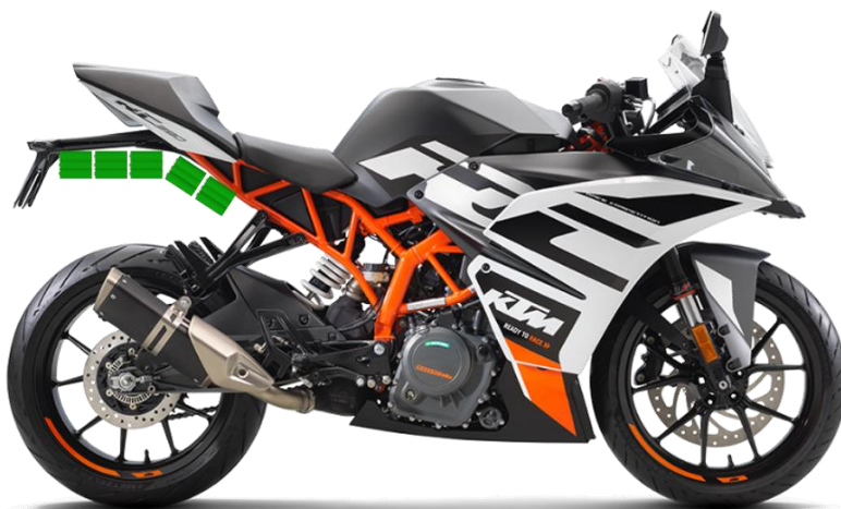
Obr. 37 Umístění trakční baterie [187]
