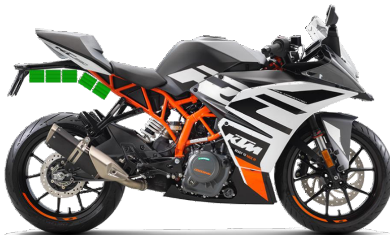
Obr. 37 Umístění trakční baterie [187]
