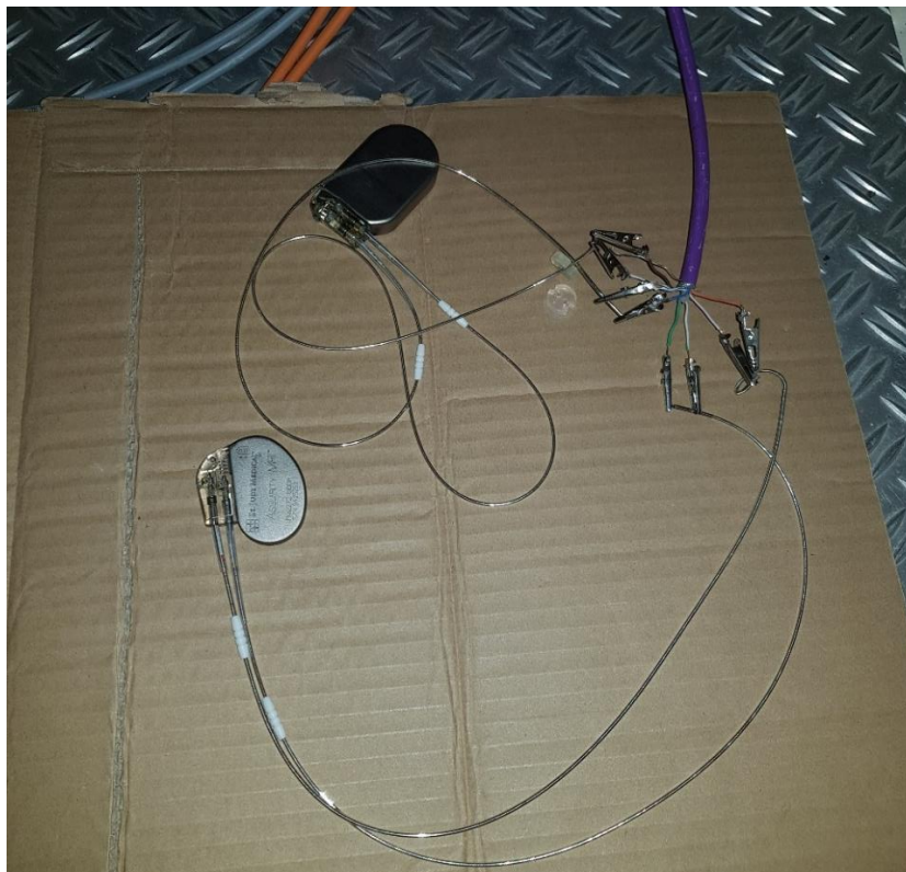
Obr. B 1 Umístění kardiostimulačních přístrojů uvnitř hyperbarické komory a napájené krokosvorky na vnitřní konec měřícího kabelu fialové barvy [Zdroj: autor]
