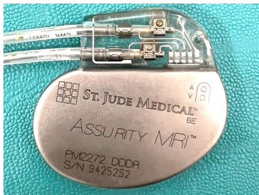
Obr. 16 Dvoudutinový kardiostimulátor [Zdroj: autor]
