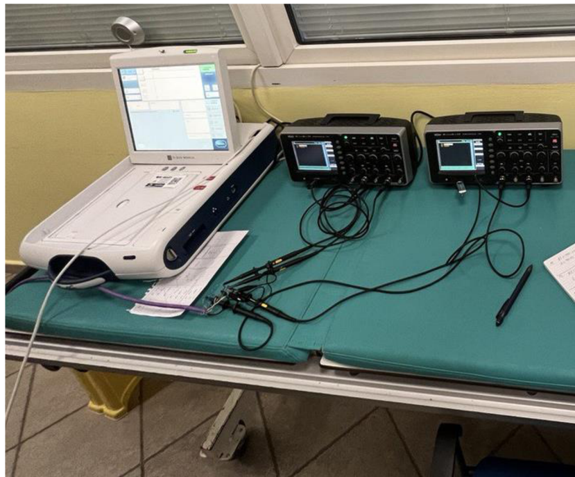
Obr. B 3 Druhý konec měřicího kabelu s napájenými odpory a měřící sondy zapojené do osciloskopů [Zdroj: autor]
