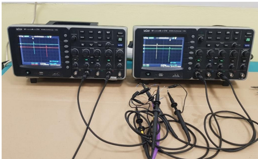
Obr. 25 Zkušební měření (vlevo signál ICD, vpravo signál PCM) [Zdroj: autor]
