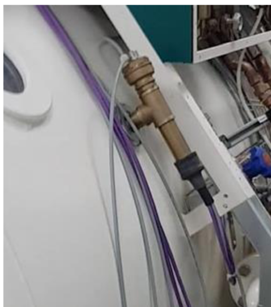
Obr. B 1 Umístění kardiostimulačních přístrojů uvnitř hyperbarické komory a napájené krokosvorky na vnitřní konec měřícího kabelu fialové barvy [Zdroj: autor]
