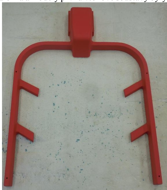
Obr. 8.5: Vtoková soustava s dopadovou jamkou.
