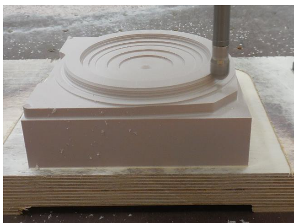
Obr. 7.1: Ukázka konturového dokončování frézou \text{Ø}16 mm.
