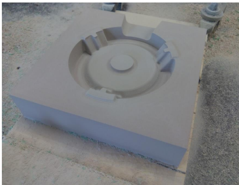
Obr. 7.6: Obrobená spodní část jaderníku.
