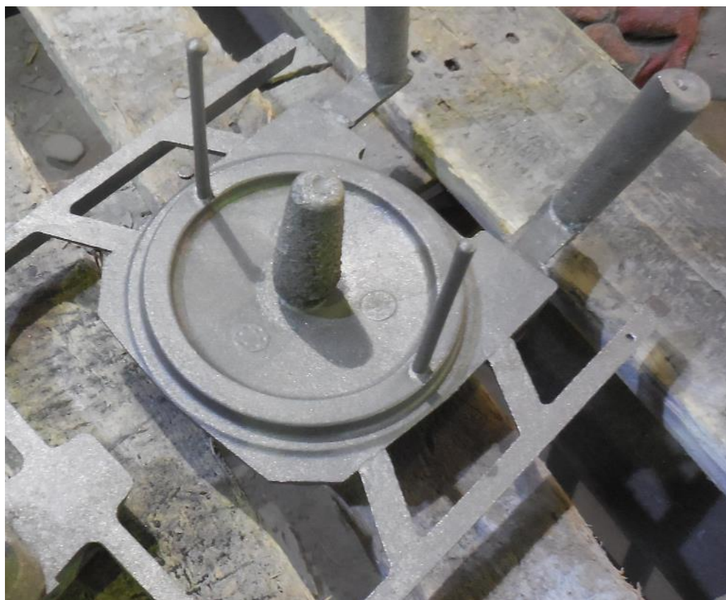
Obr. 9.8: Otryskaný odlitek s vtokovou soustavou, nálitkem a průduchy.
