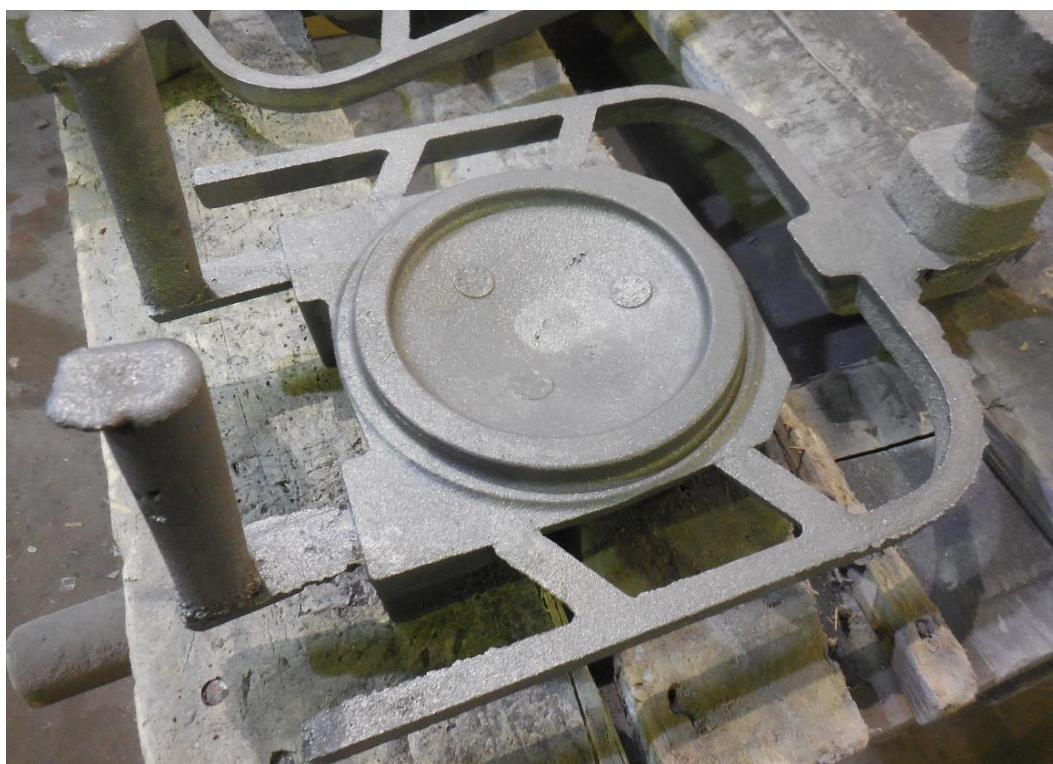
Obr. 9.9: Otryskaný odlitek s vtokovou soustavou bez nálitku a průduchů.
