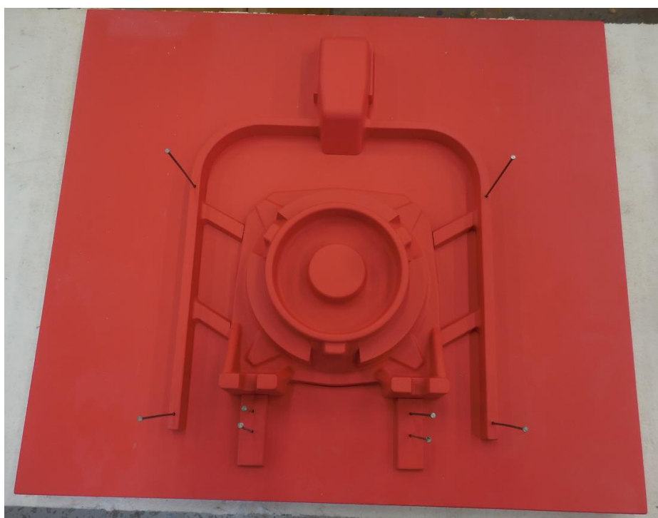
Obr. 8.6: Model na podložce s vtokovou soustavou a výfuky.
