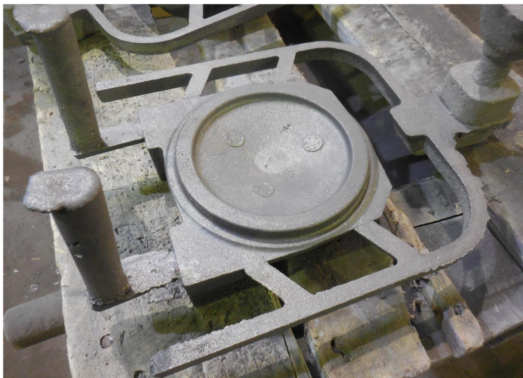
Obr. 9.9: Otryskaný odlitek s vtokovou soustavou bez nálítku a průduchů.
