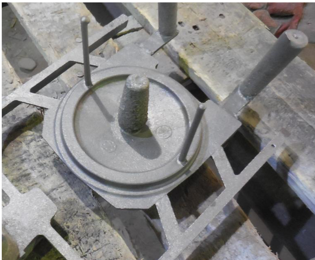
Obr. 9.8: Otryskaný odlitek s vtokovou soustavou, nálítkem a průduchy.
