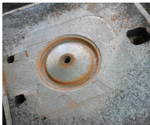
Obr. 9.3: Formování vrchní části formy.
