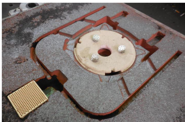
Obr. 9.6: Usazený filtr, jádro a podpěrky jádra.
