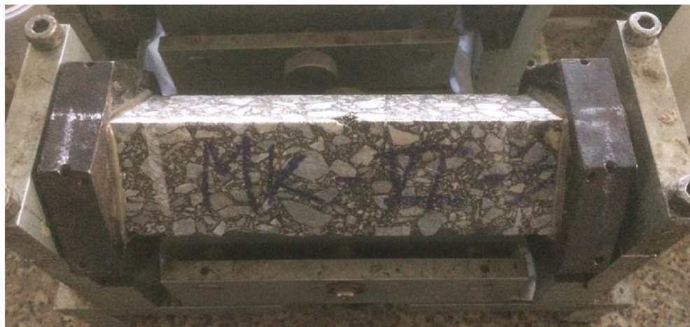
Obrázek 26: Vzorek připevněný v ocelové formě
