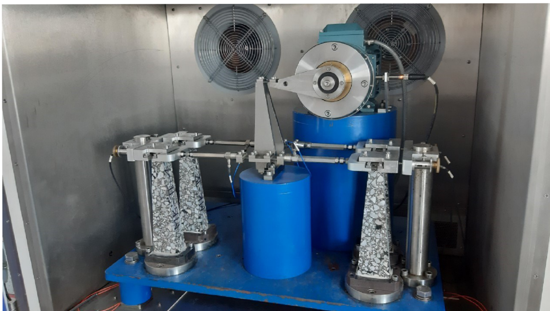
Obrázek 29: Upevněné vzorky v zařízení COOPER
