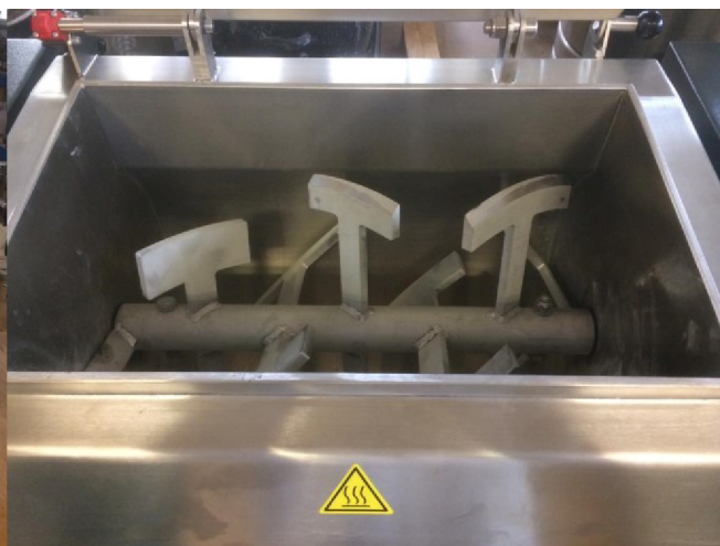
Obrázek 20: Detail hřídele míchačky
