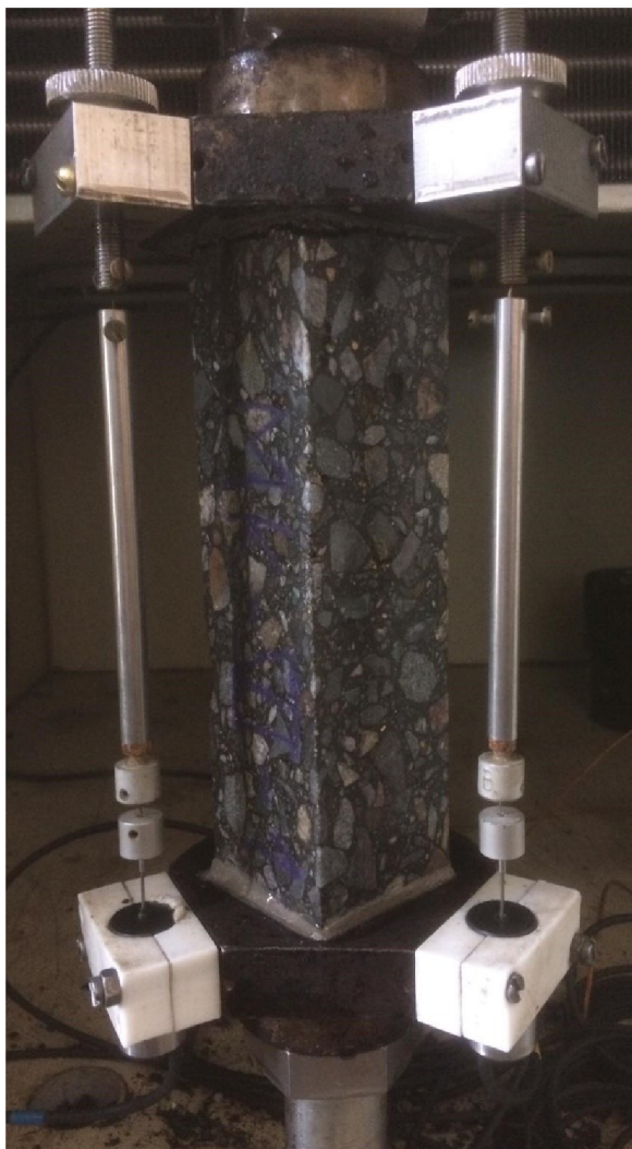
Obrázek 27: Vzorek připevněný v zařízení Cyklon -40
