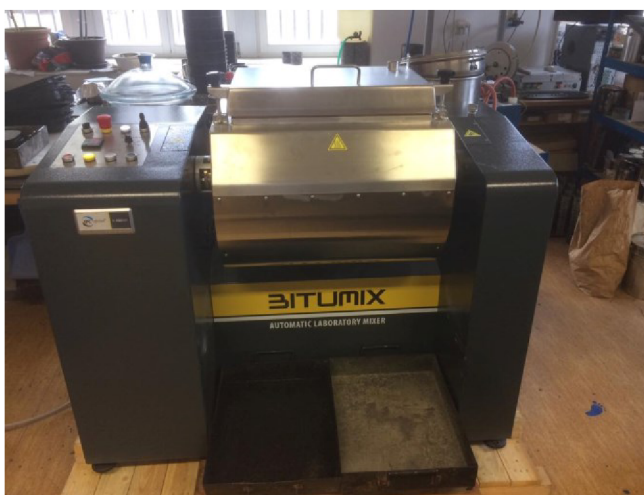
Obrázek 21: Laboratorní míchačka BITUMIX
