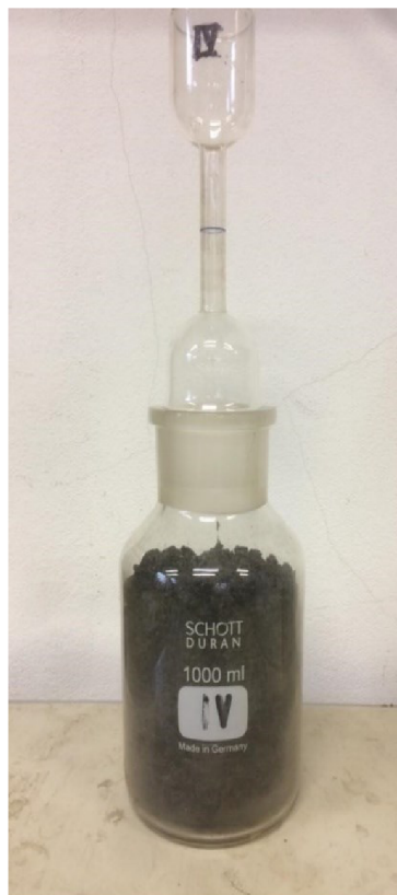
Obrázek 18: Pyknometr naplněný asfaltovou směsí
