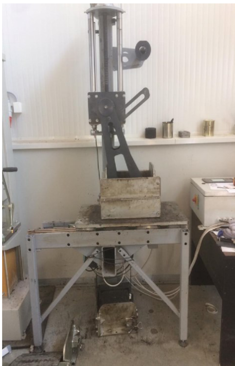
Obrázek 22: Zhutňovač s válcovou plochou
