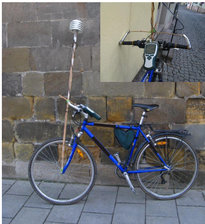
Obr. 5 Umístění radiačního krytu, teplotního spínače a dataloggeru na jízdním kole a zhotovené konstrukci
