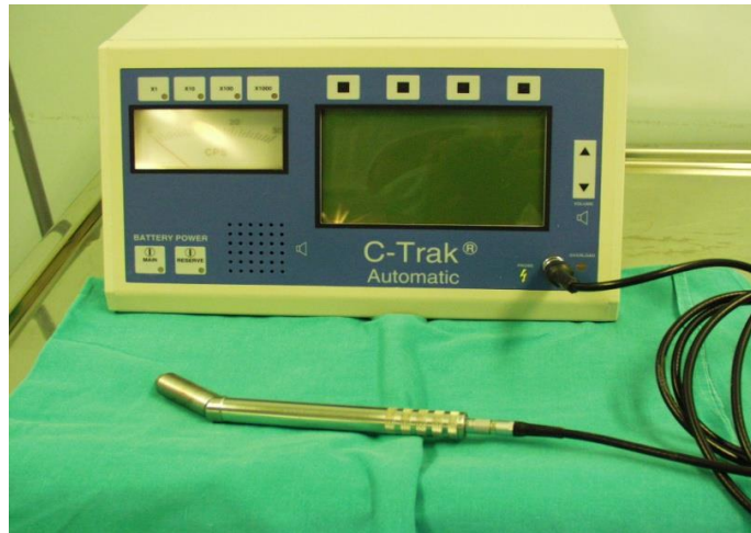
Obrázek 3.1.2-1 Příklad klasické gamasondy spojené kabelem s vyhodnocovacím zařízením
