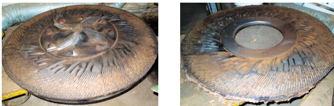
Obr. 13 Použité segmenty k výrobě vlákna MDF
