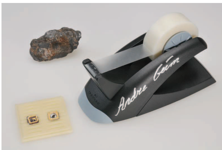
Obr. 2.2: Fotografie jednoho z prvních grafenových tranzistorů. Grafen byl získán pomocí lepicí pásky [17].
