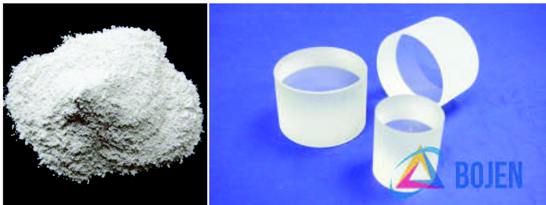
Obr. 1.1: CaF 2 ve formě prášku (vlevo) [2] a ve formě válců (vpravo) [3]. Tyto válce se užívají nejčastěji pro výrobu optických komponent.
