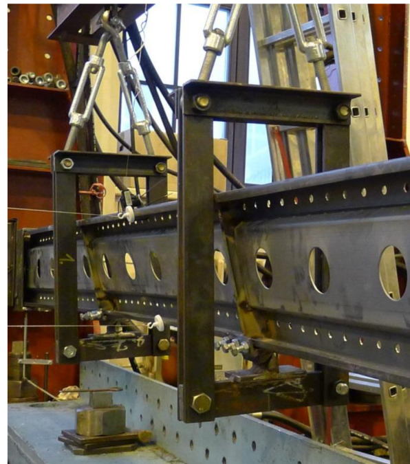
Obr. 6.42 Nosník vyztužený přičnými výztuhami
