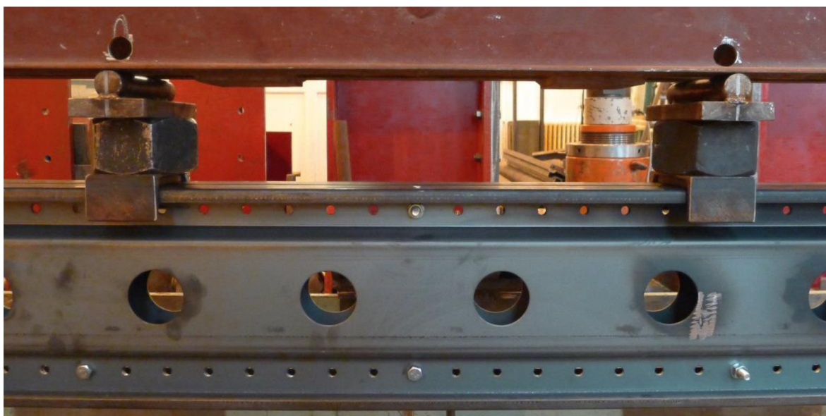
Obr. 6.19 Konstrukční řešení vnášení síly na dvojici nosníků
