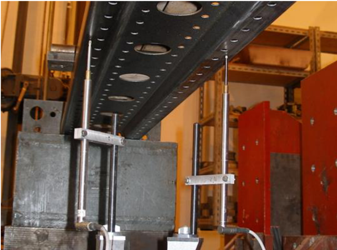
Obr. 6.24 Umístění snímačů polohy uprostřed rozpětí nosníku při ohybu na měkkou osu
