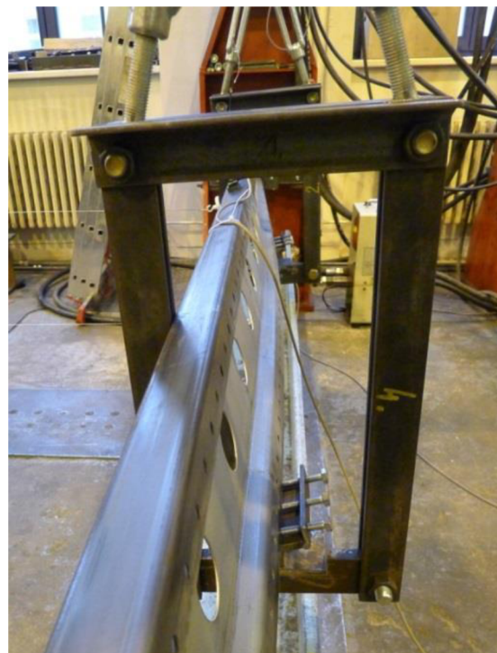
Obr. 6.40 Kontakt zkušebního tělesa s rámem táhla
