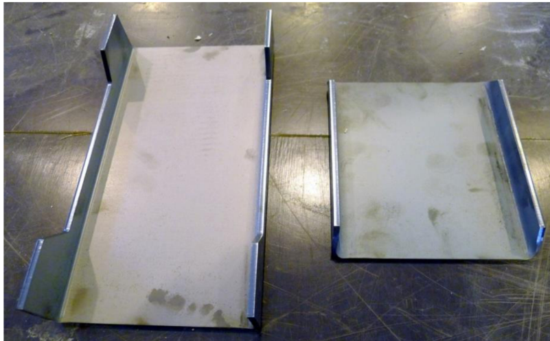
Obr. 6.12 Tvarované ohýbané plechy tloušťky 4 mm
