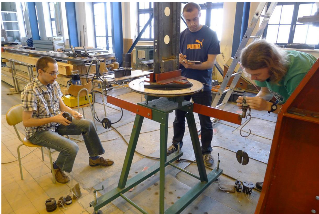
Obr. 6.8 Vnášení zatížení přes ocelová lanka na zatěžovací kotouč
