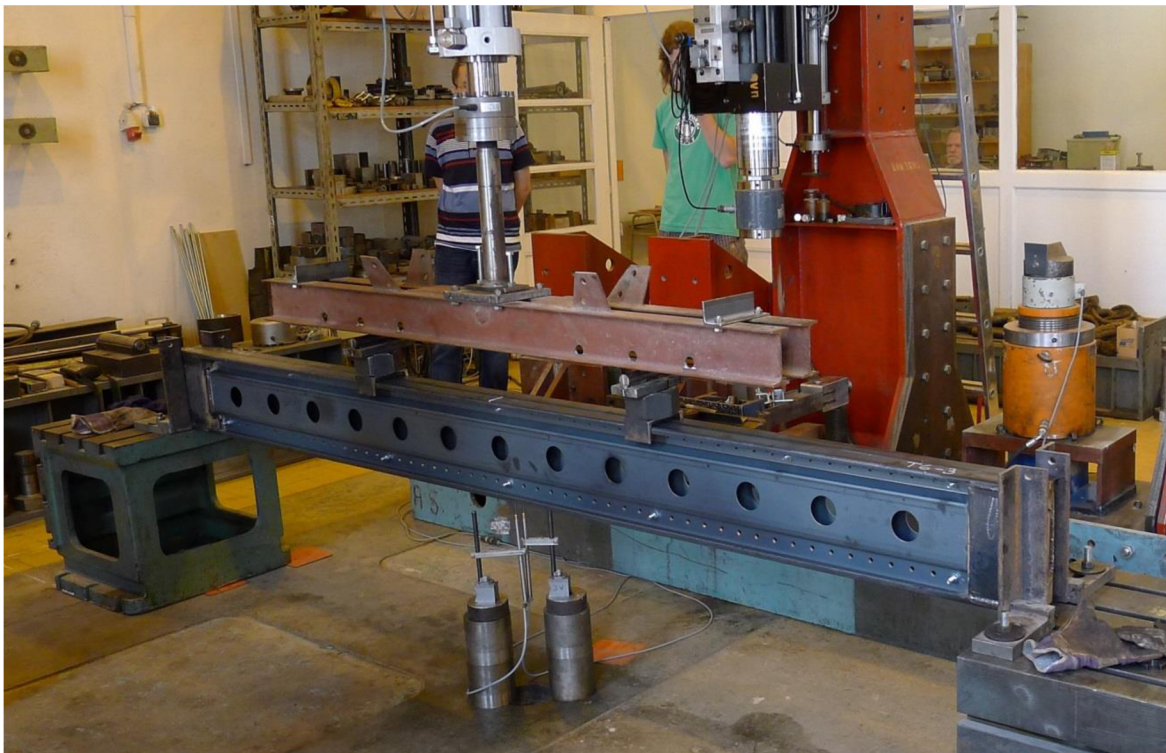
Obr. 6.18 Schéma zkušební sestavy s roznosem síly do třetin rozpětí
