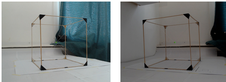
Obrázek 2.3: Výstup z programu (příloha 02), který zobrazuje stejný obraz ze dvou různých kamer s vyznačením zeleným křížkem, pro nastavení kamer.
