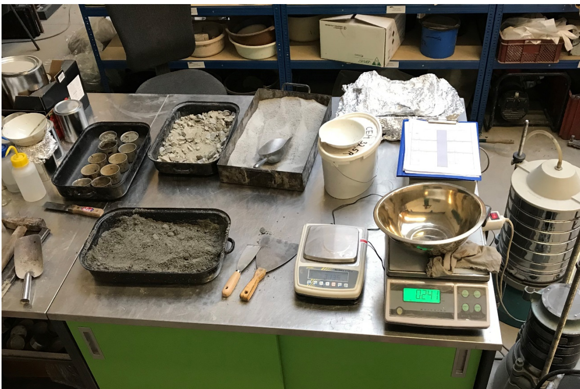
Obr. 8 - Příprava směsi materiálu při výrobě zkušebních těles
