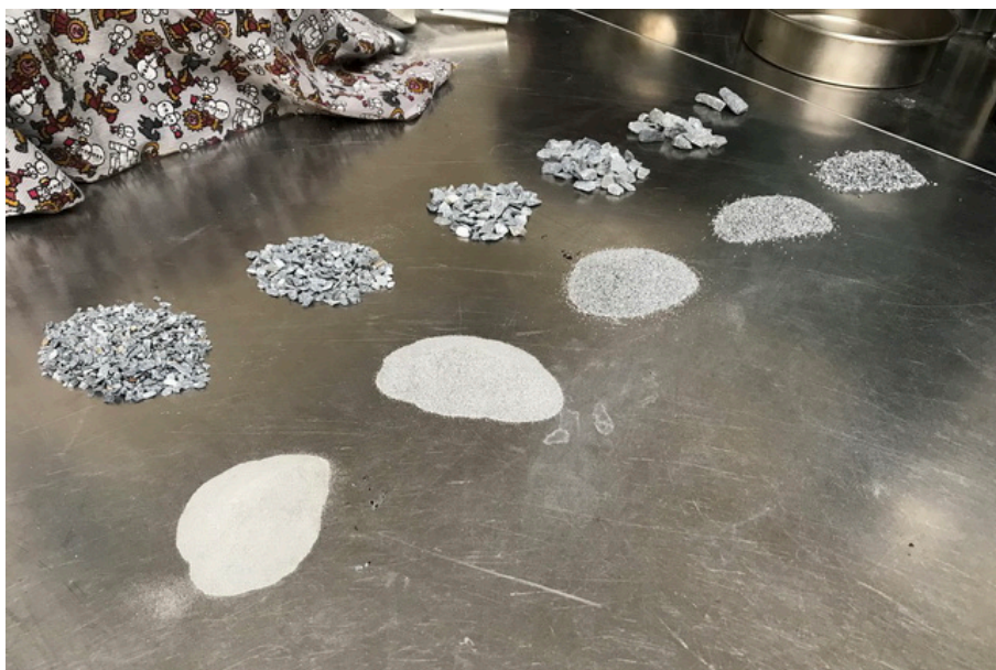
Obr. 5 - Materiál zachycený na jednotlivých sítích
