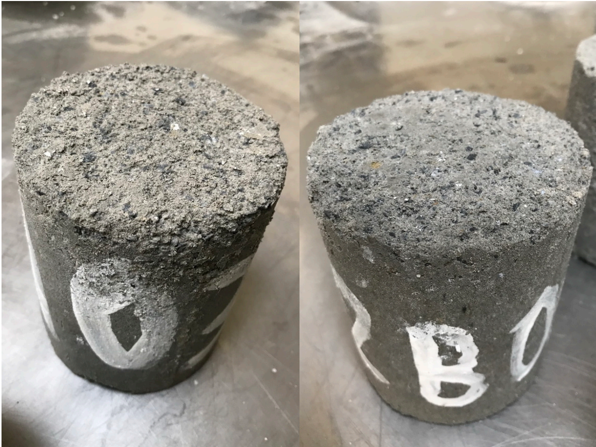
Obr. 14 - Vzorky po mrazových cyklech před zkouškou (směs A vlevo, směs B vlevo)
