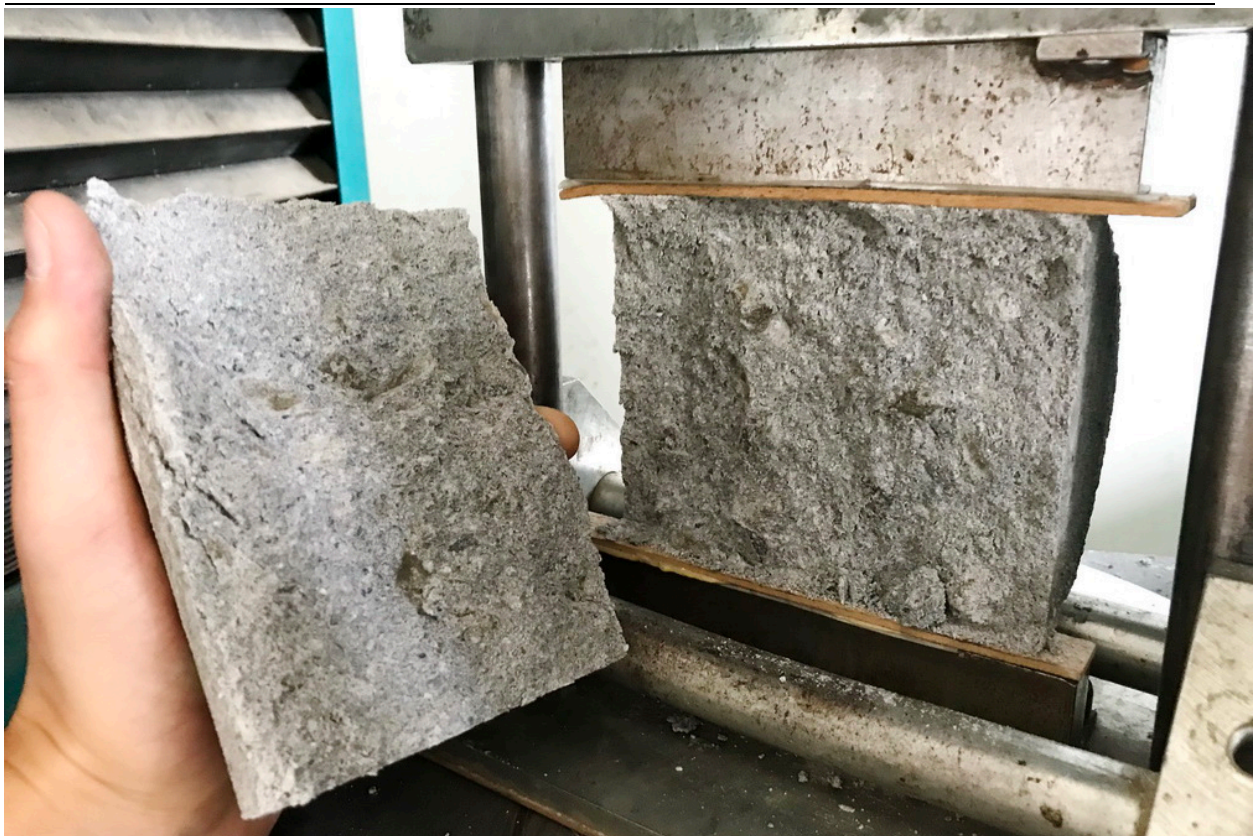
Obr. 13 - Porušení vzorku po zkoušce v příčném tahu
