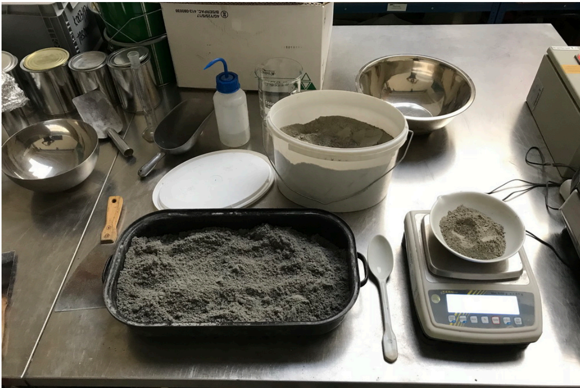
Obr. 6 - Příprava směsi pro Proctorovu zkoušku
