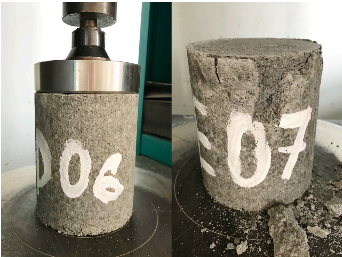
Obr. 11 - Zkouška pevnosti v tlaku v lisu
