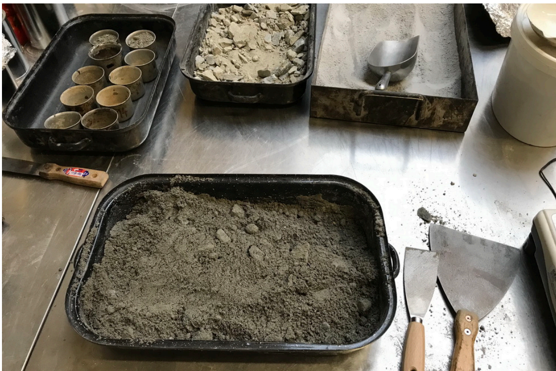
Obr. 9 - Příprava záměsi při výrobě zkušebních těles
