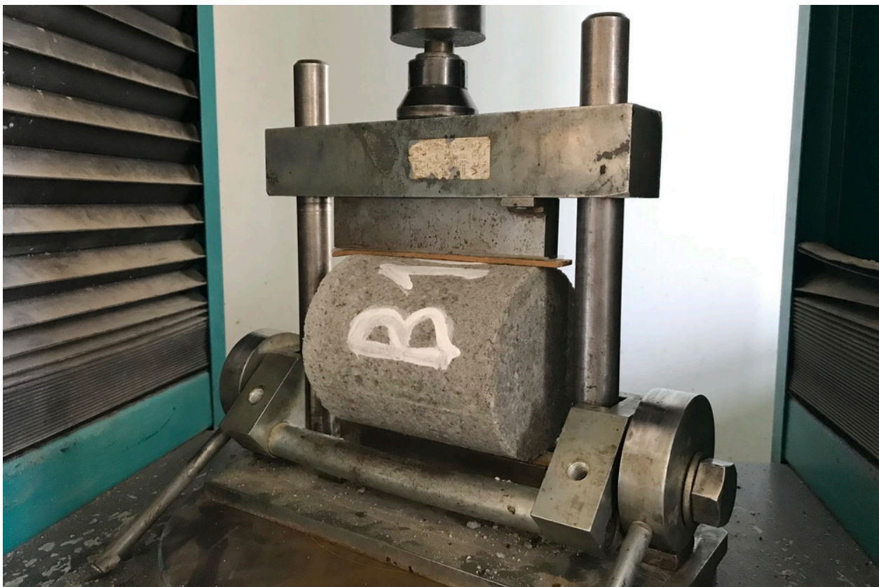
Obr. 12 – Zkouška pevnosti v příčném tahu v lisu
