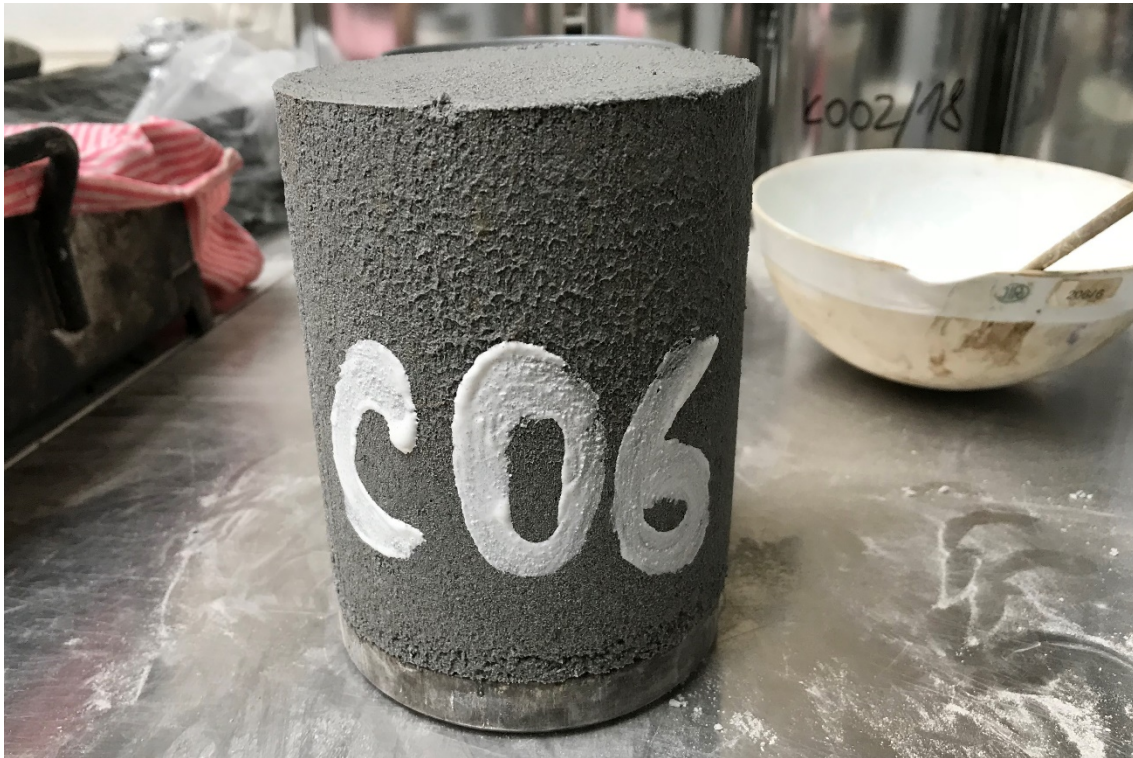
Obr. 10 - Označování zhotoveného zkušebního vzorku
