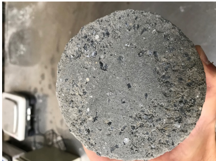
Obr. 16 - Vzorek směsi B po mrazových cyklech před zkouškou
