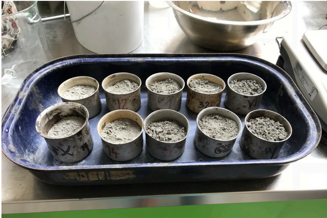
Obr. 7 - Vzorky vlhkosti z Proctorovy zkoušky
