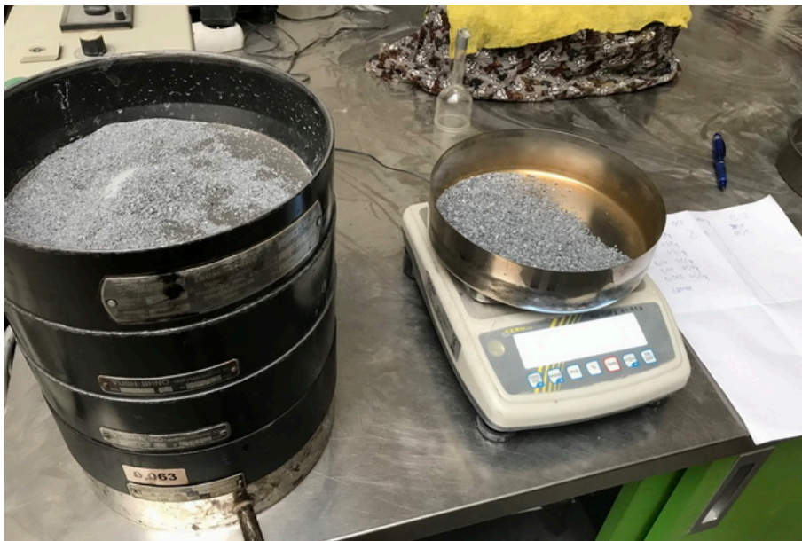
Obr. 4 - Ruční prosévání a vážení zůstatku materiálu na sítě
