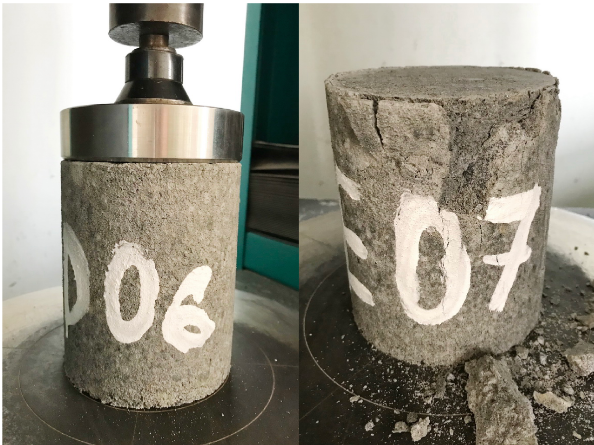
Obr. 11 - Zkouška pevnosti v tlaku v lisu
