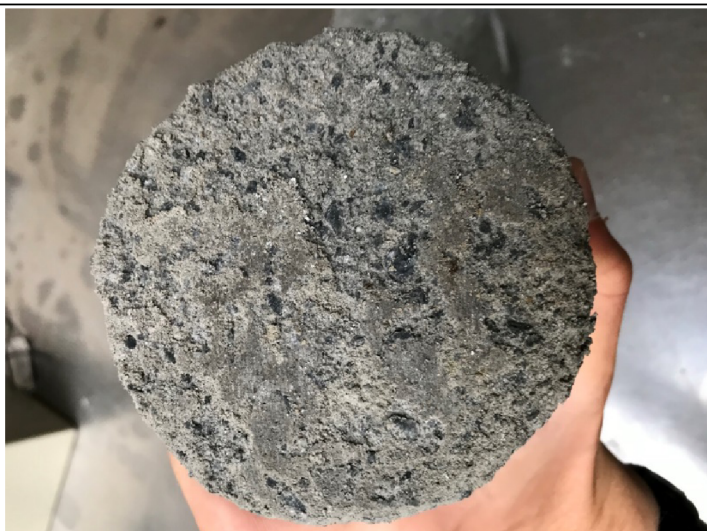
Obr. 15 - Vzorek směsi A po mrazových cyklech před zkouškou
