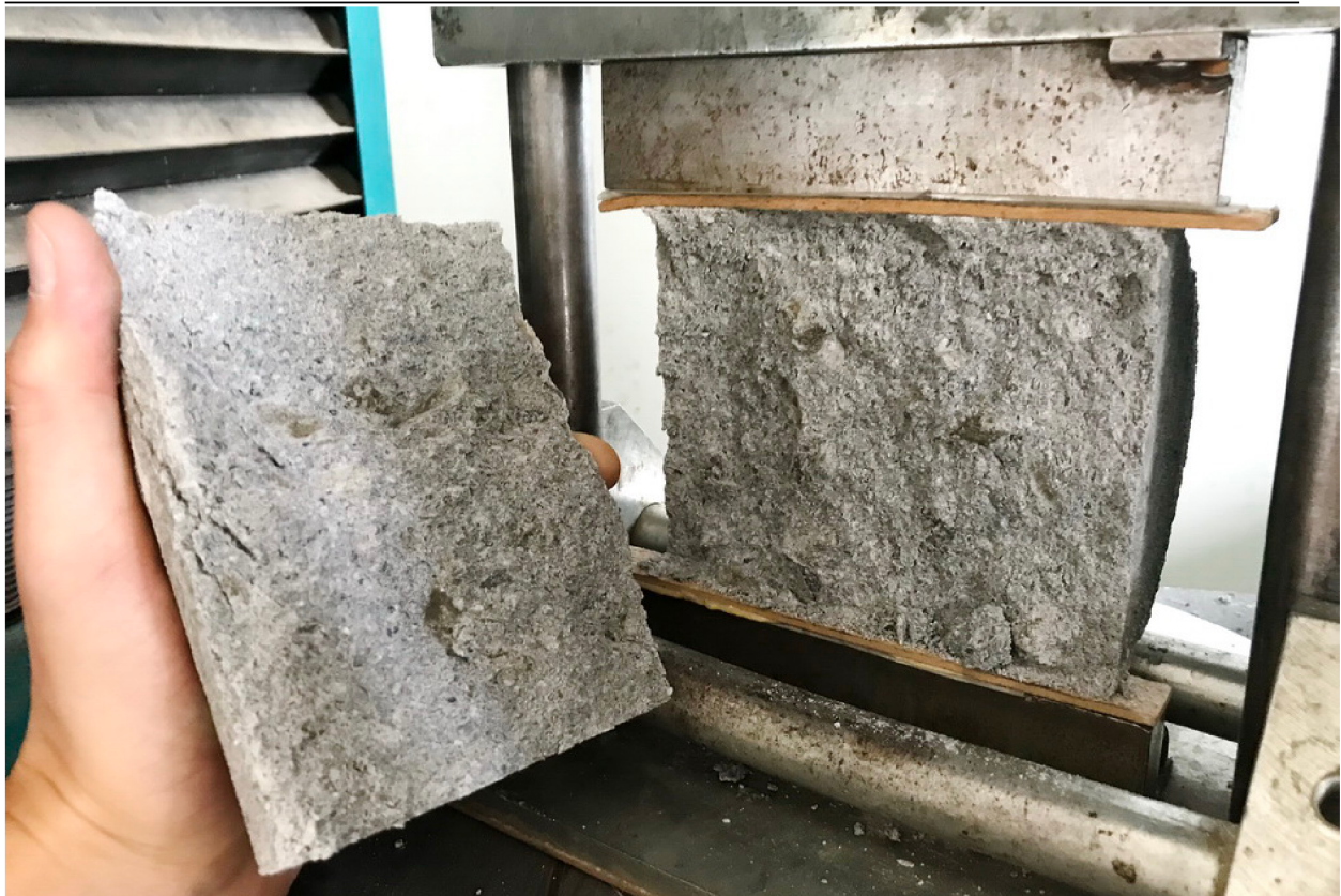
Obr. 13 - Porušení vzorku po zkoušce v příčném tahu
