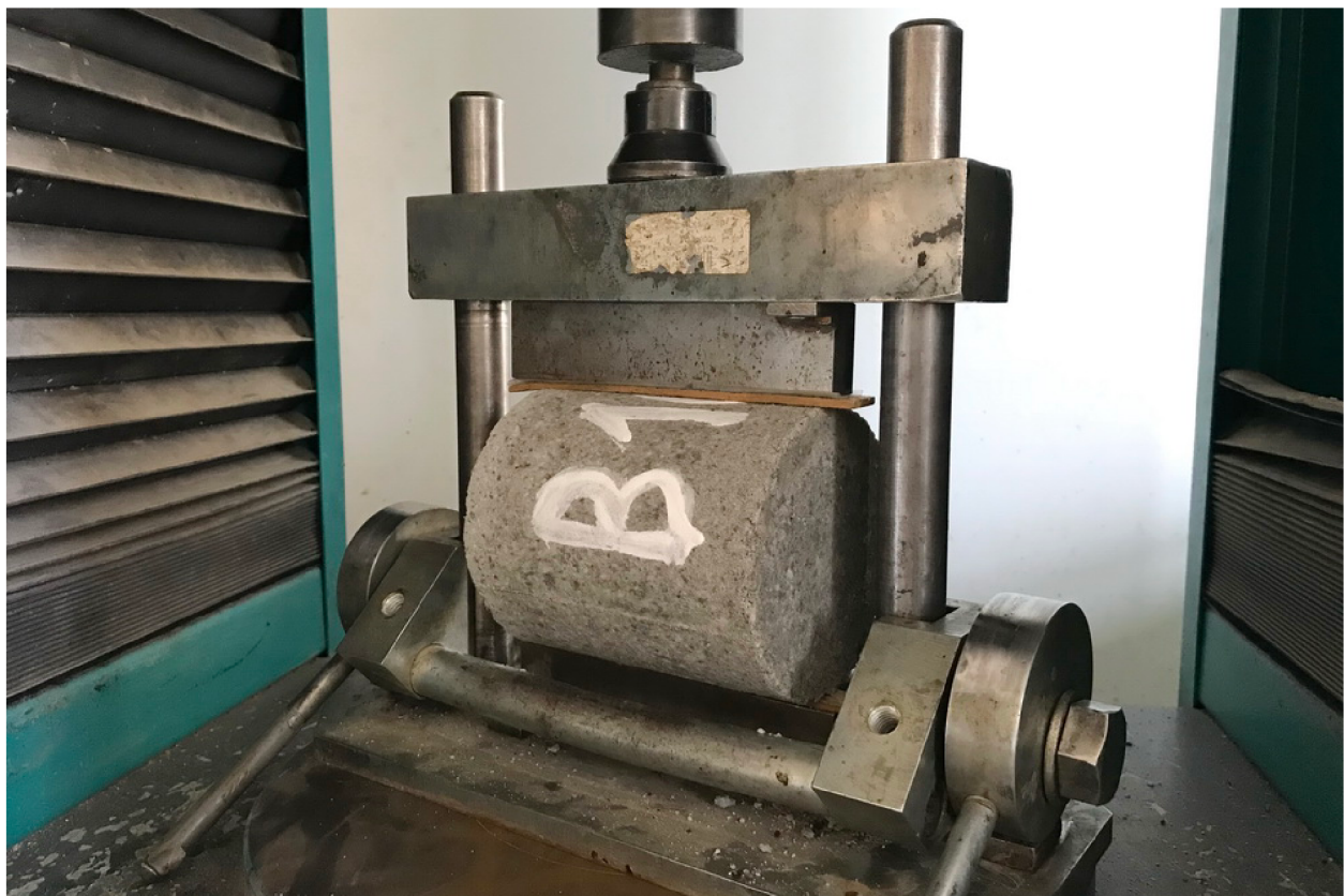
Obr. 12 – Zkouška pevnosti v příčném tahu v lisu
