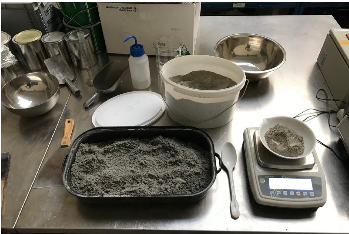
Obr. 6 - Příprava směsi pro Proctorovu zkoušku
