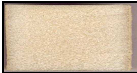
Obr. 59: Ko-extrudovaná zátka – podélný řez ( zdroj: www.nomacorc.com, 2014 )
