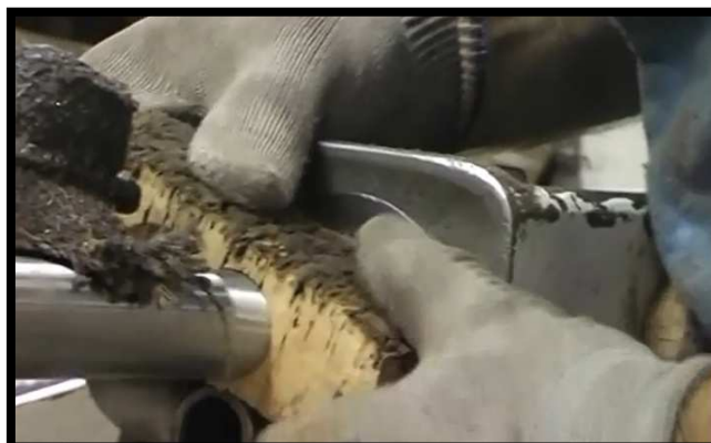
Obr. 29: Detail průrazu raznice (zdroj: www.korek.cz , 2014)
