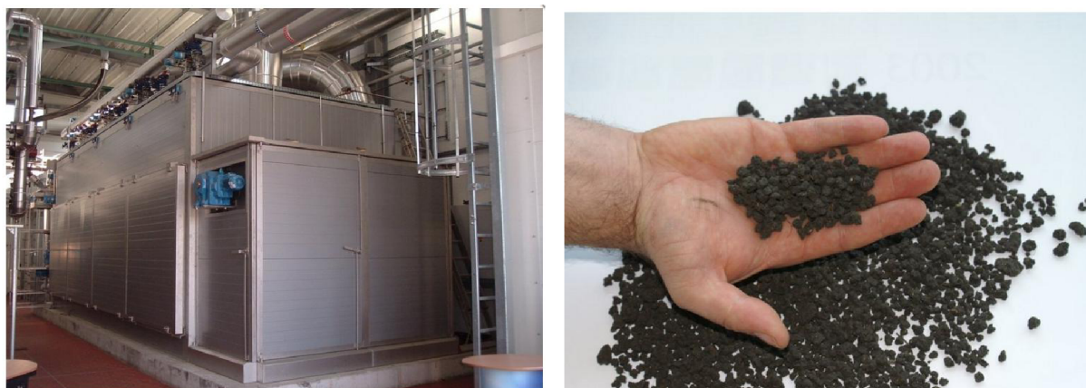
Obr. 2-18 Pásová sušárna HUREB BT a vysušený kal [49]
