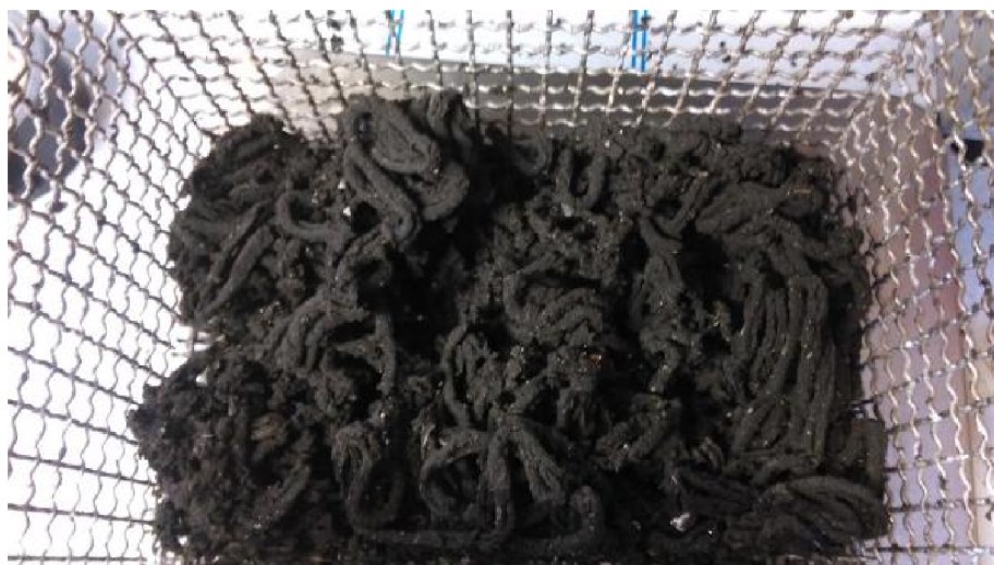
Obr. 4-7 Pohled na vysušený vzorek kalu po 165 min
