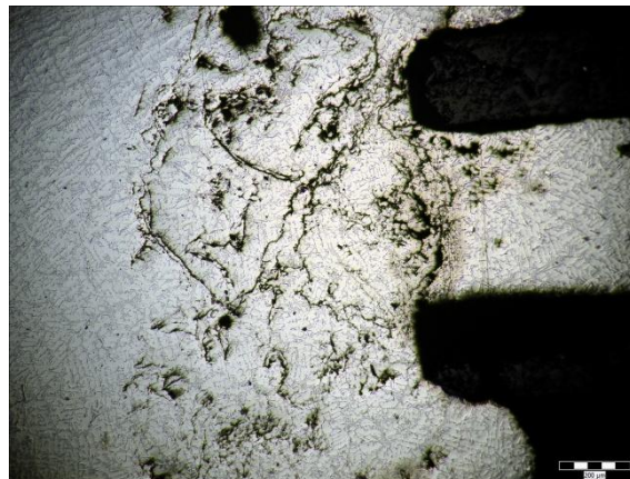
Obr. 3.31. Filtrační koláč vytvořený na čele filtru.
