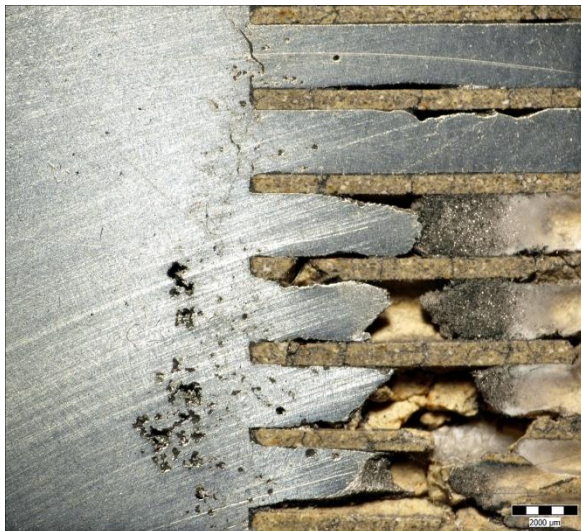
Obr. 3.15 Filtrační koláč vytvořený na čele filtru 0818.
