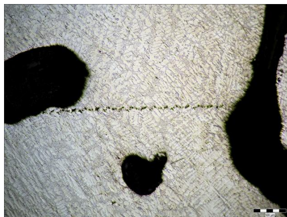
Obr. 3.31 Můstek porezity vzniklé na vměstku.
