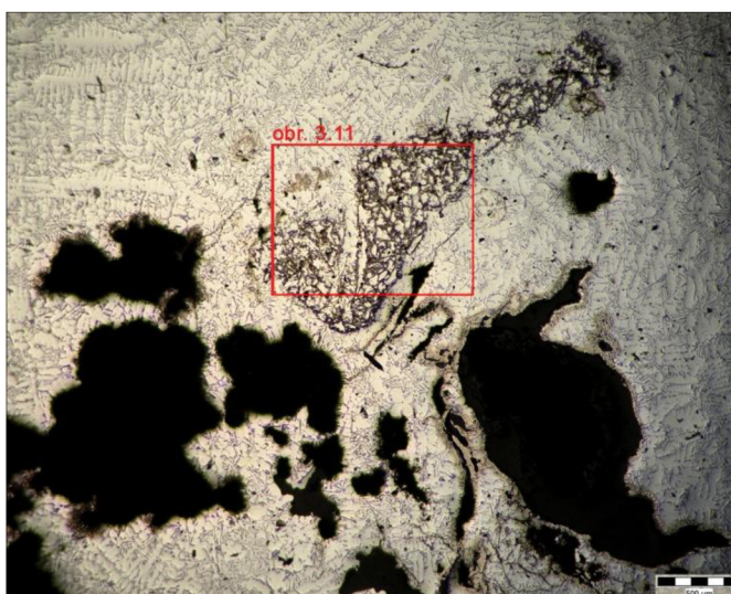
Obr. 3.10 Rozměrný vměstek zachycený uvnitř filtru.
