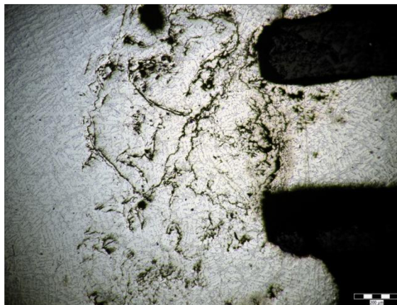
Obr. 3.31. Filtrační koláč vytvořený na čele filtru.
