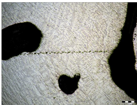
Obr. 3.31 Můstek porezity vzniklé na vmětku.
