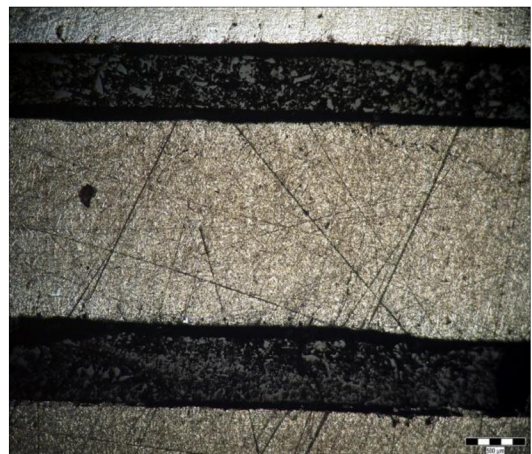
3.17 Detail kanálu uvnitř filtru.
