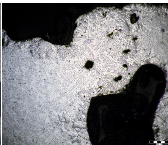
Obr. 3.20 Kalové fáze uvnitř filtru.
