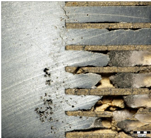
Obr. 3.15 Filtrační koláč vytvořený na čele filtru 0818.
