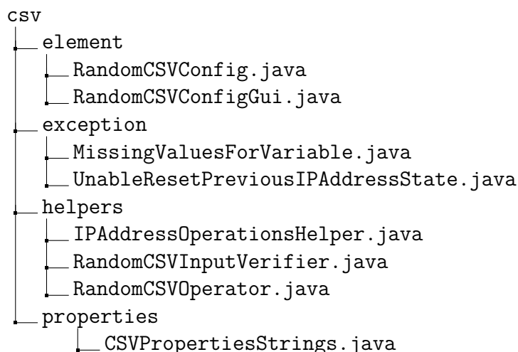
Obr. 9.2: Struktura konfiguračního prvku CSV Dataset for set and randomize IP
