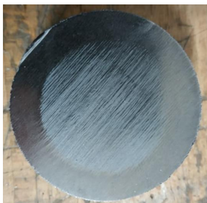
Obr. 31 Odebraný vzorek ze zakalené tyče
