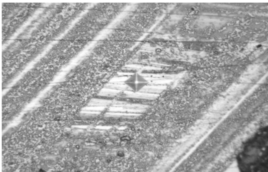
Obr. 36 Vpich mikrotvrdoměru do zakalené martenzitické struktury
