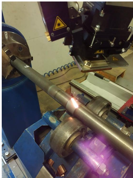
Obr. 30 Průběh laserového kalení
