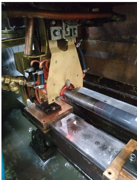
Obr. 26 Začátek indukčního kalení
