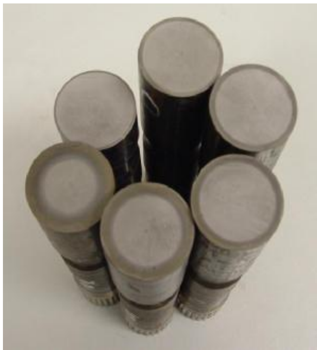
Obr. 6 Povrchově zakalené válečky s různou tloušťkou zakalené vrstvy [19]
