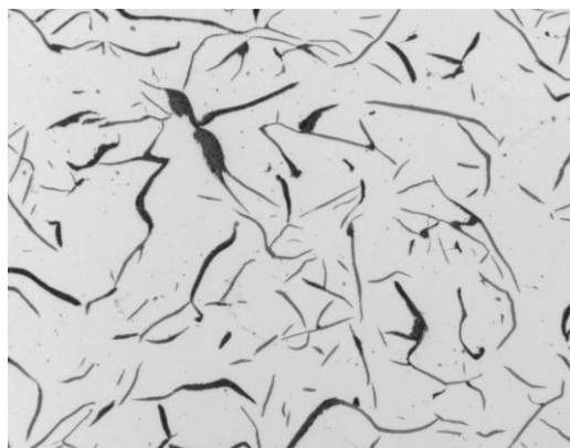
Obr. 1 Struktura litiny s lupínkovým grafitem [15]
