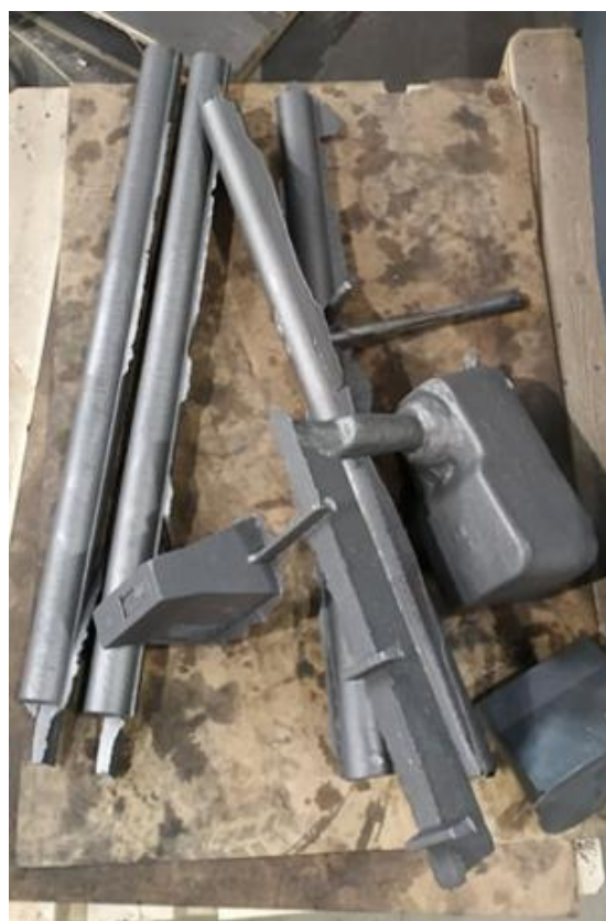
Obr.19 Odlitky po vytlučení a tryskání
