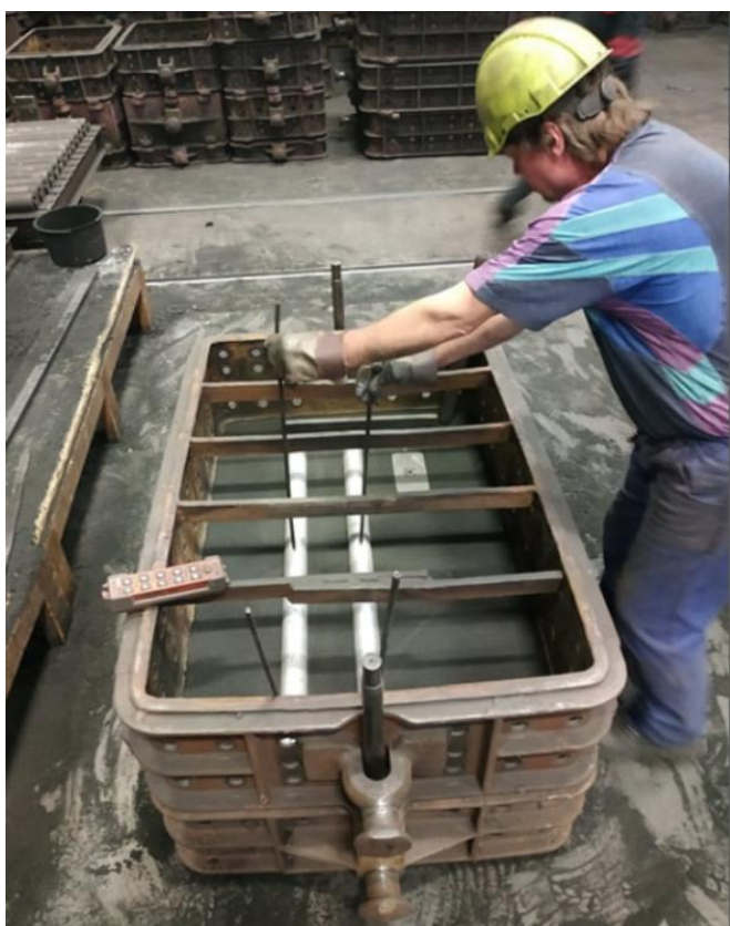
Obr.18 Zaformování dřevěného modelu
