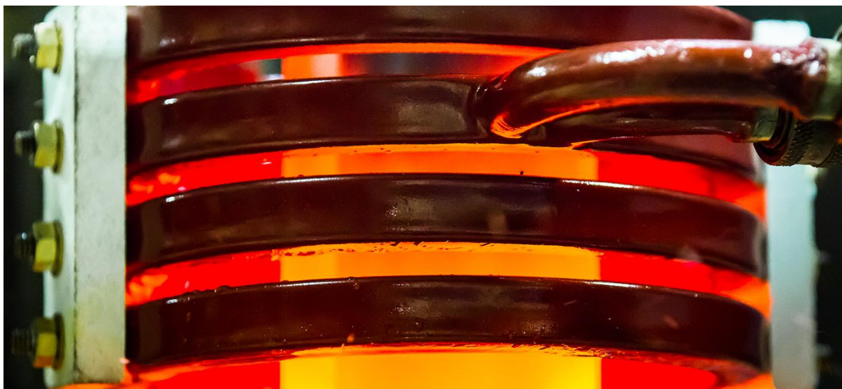
Obr. 8 Detail měděné, vodou chlazené, cívky [11]
